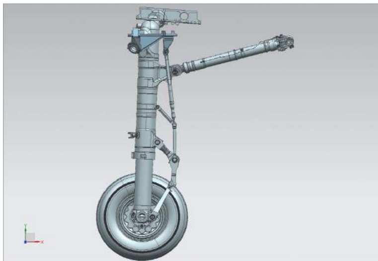
Рис. 5. 3D-модель стойки шасси
