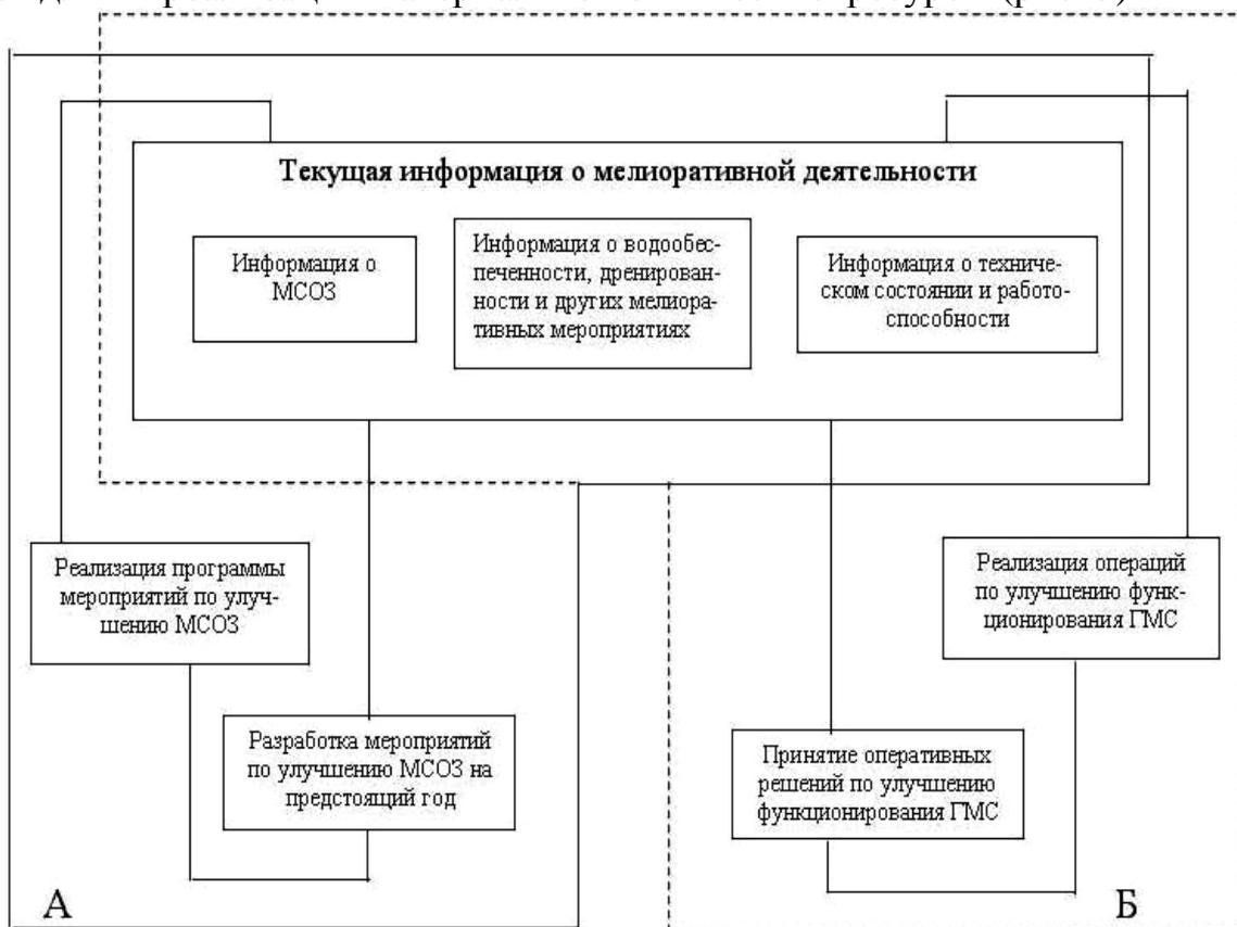
**Рис.3.** Блок-схема тактического и оперативного управления МСОЗ А – управление МСОЗ выработкой программы мероприятий на предстоящие годы. Б – текущее управление функционирования ГМС
