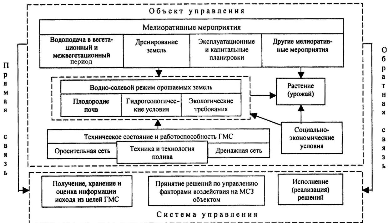
Рис.4. Технологическая схема функционирования систем мониторинга и управления ГМС
