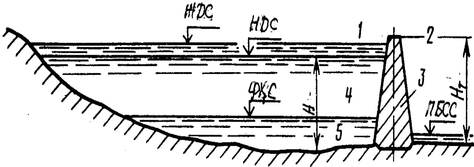
Gruntli materiallardan barpo etiladigan to'g'onli suv ombori gidrouzeli sxemasi: 1 va 2-yuqori va pastki beflar; 3-to'g'on; 4 va 5-suv omboridagi foydali va foydalanimaydigan hajmlar  $H$ -suv chuqurligi;  $H_T$ -to'g'on balandligi.
