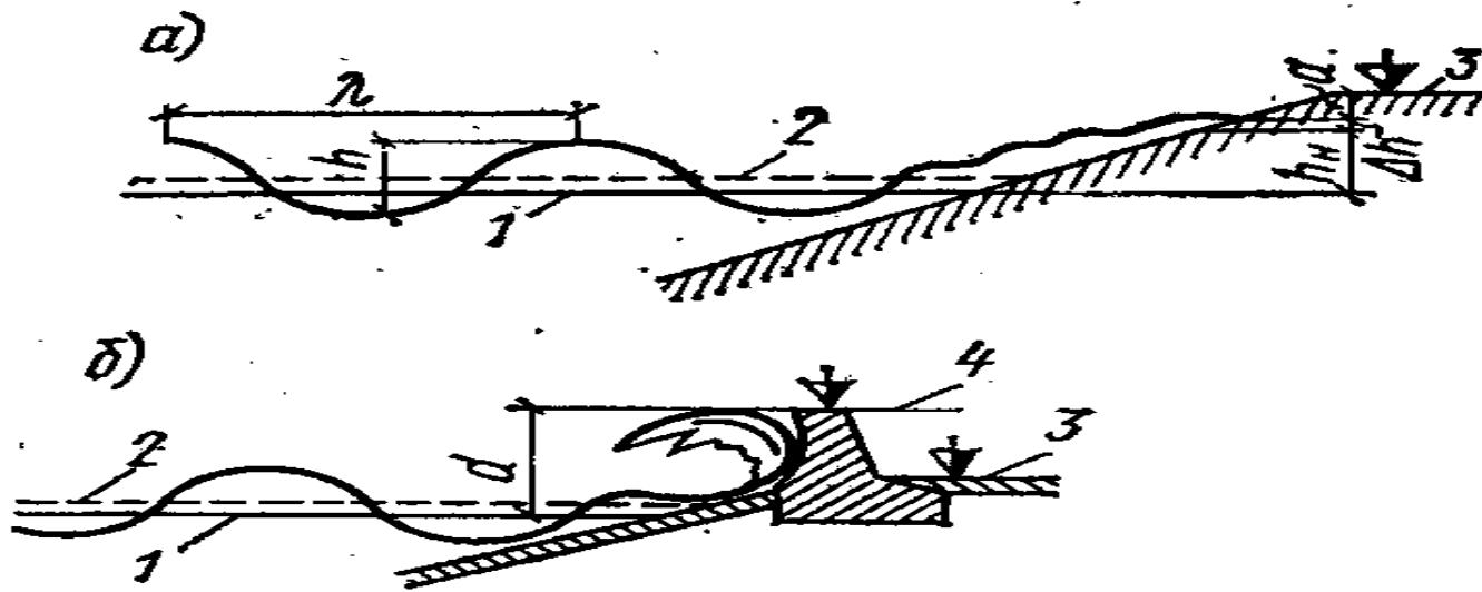
To'g'on tepasining sath belgisini aniqlash sxemalari: a-paraketsiz; b-paranet bilan; 1-hisobiy statik sath; 2-to'lqinning o'rtacha chizig'i; 3- to'g'on tepasi; 4-parapet tepasi
