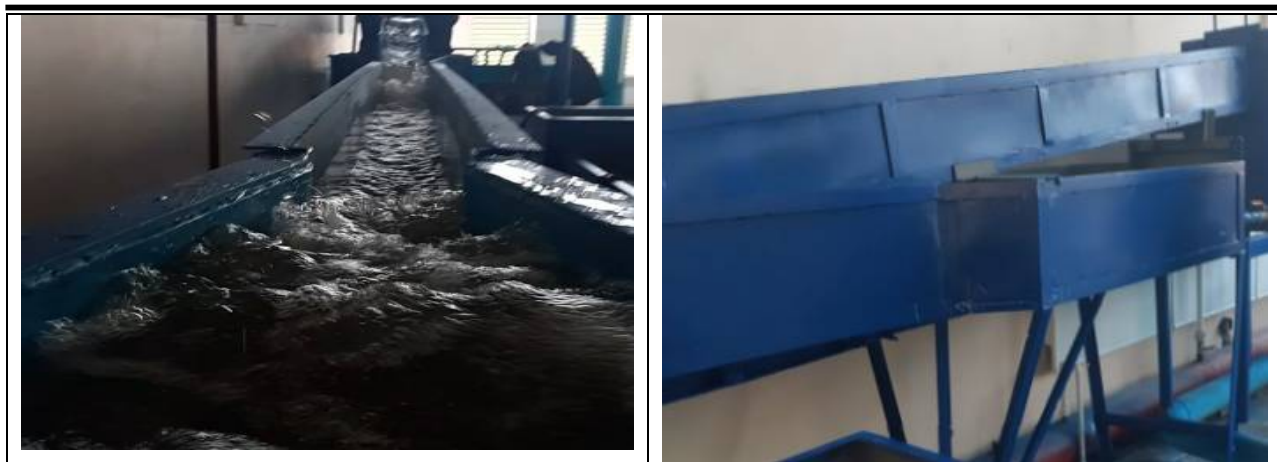
Рис.6. Модель водобойного колодца с боковым отводом потока
