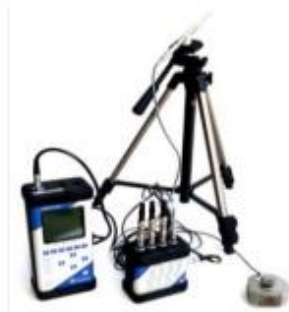
Рис. 1.1. Цифровой анализатор звука и вибрации 1-го класса точности, сочетающий функции шумомера и виброметра - SVAN 912 AE.
