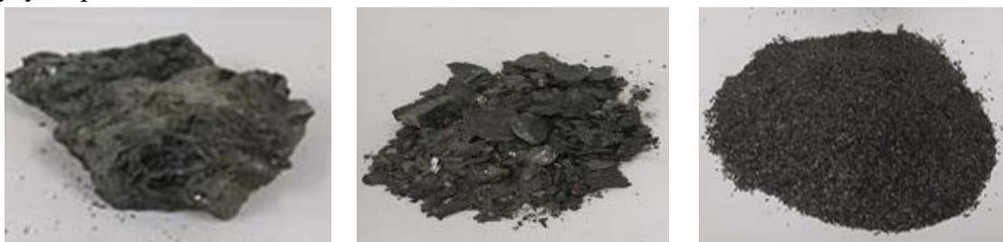
1-расм. Тебинбулоқ вермикулит конидан олинган вермикулит рудаси (а) , руданинг майдалангани (б) ва бойитилган майда ўлчамли концентрати
