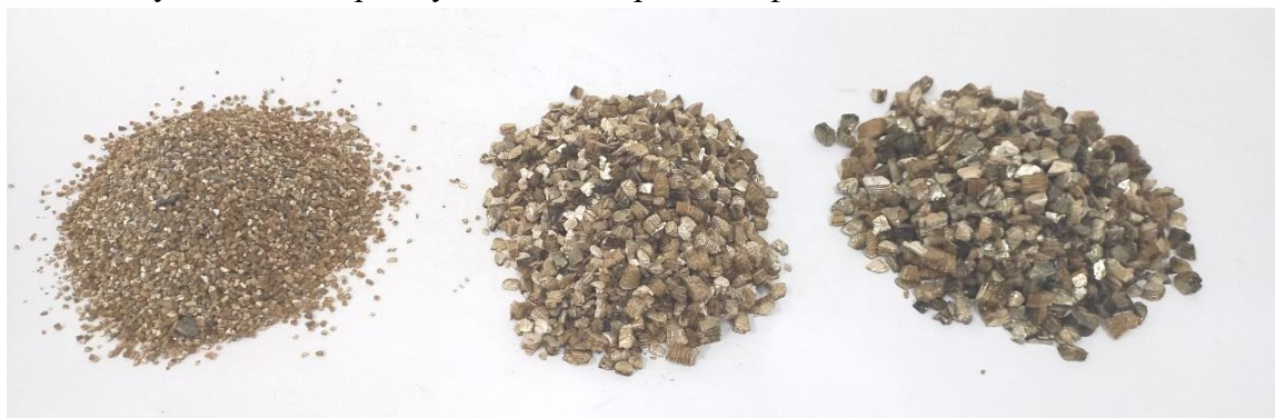
2-расм. Майда ва йирик фракцияли вермикулит концентратлари ва уларнинг кўпчитилган ҳолатдаги намуналари
