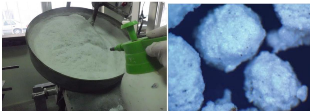
1-rasm. Ko'pchitilgan perlit yuzasini pellet mashinasida kislota/silikat bilan ishlov berish bilan qoplash
