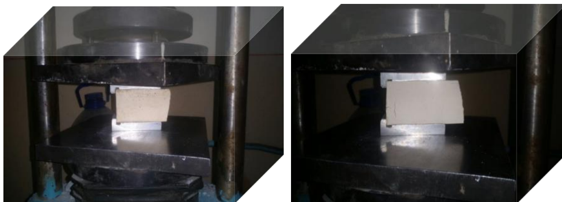
7- rasm. Siqilishga mustahkamlik chegarasini aniqlash.
