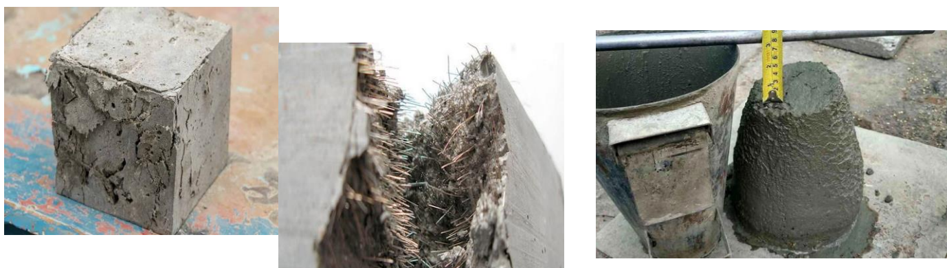
Расм 3. а) Оғир бетон таркибига (POLIMIX x2-222) суперпластификатори қушиб тайёрланган намуналар. б) конус чуқмаси.
