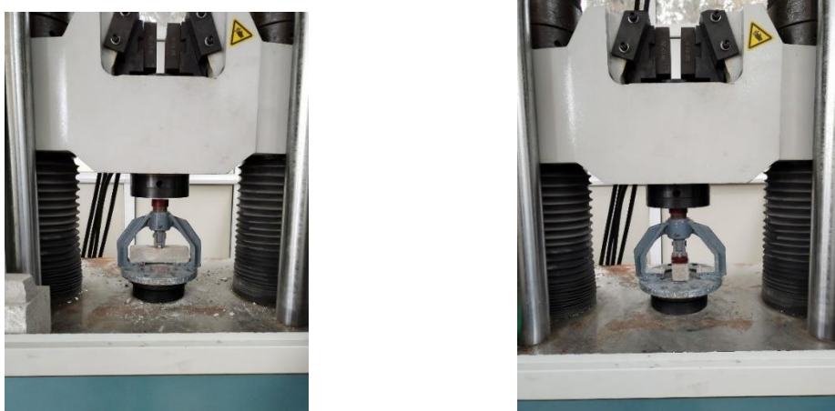
1-rasm. Sementning egilishga va siqilishga mustahkamligini aniqlovchi qurilma.
