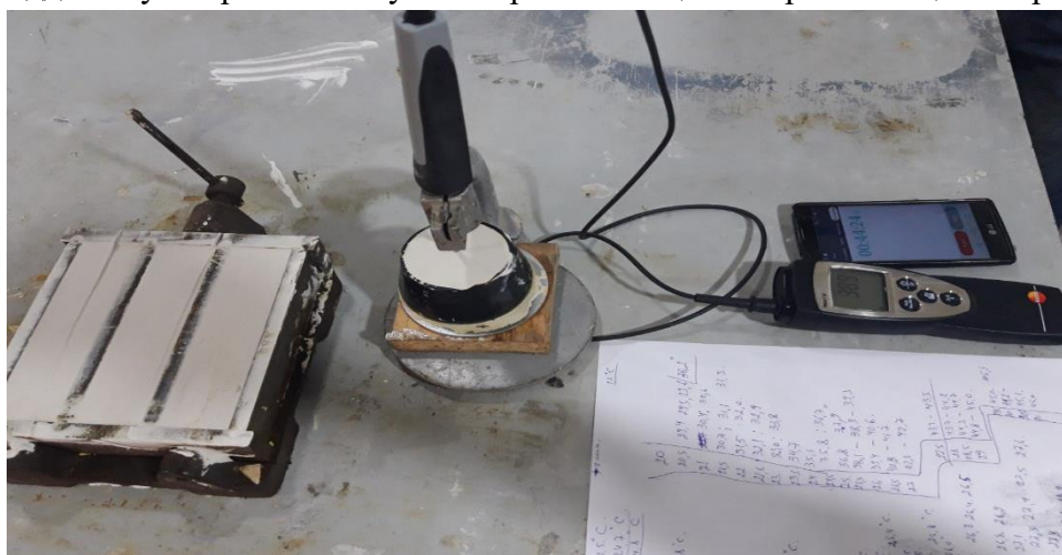
1-расм. Г10 маркадаги қурилиш гипсининг гипсининг иссиқлик ажраб чиқишини аниқлаш.
