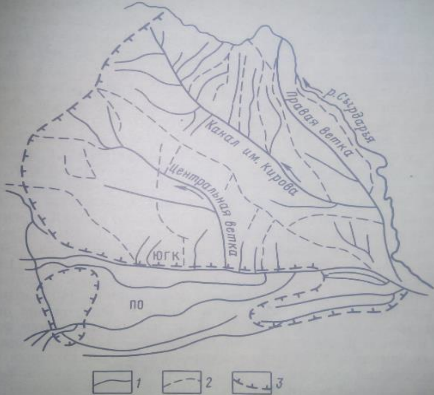
Рис. 45. Схема техногенной нагрузки на окружающую среду в Голодной степи: 1 — ирригационные каналы; 2 — коллекторная сеть; 3 — контуры массивов орошения; ПО — площади, пригодные для орошения.
