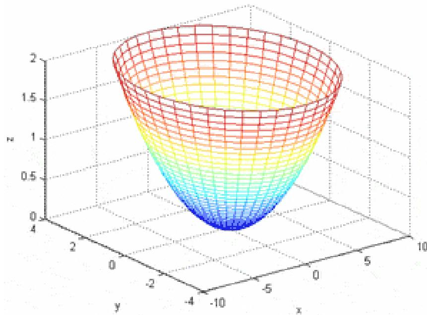
Elliptik paraboloidning  $z = h$  gorizontal tekisliklar bilan kesimida ellipslar hosil bo‘ladi:
