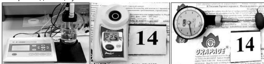
1-расм. Узумнинг сифат хусусиятларини аниқлашда фойдаланилган лаборатория жиҳозлари: а) иономер; б) рефрактометр; с) пенетрометр.
