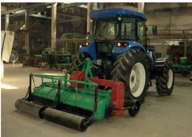
Рис. 1. Комбинированная машина, снабженная фартуком-выравнивателем, работающим совместно с кожухом ротора в режиме клапана
