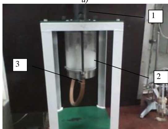
1 – электропривод Makita 9565CV; 2 – реакционная зона аппарата; 3 – генератор гидродинамических колебаний роторного типа.
