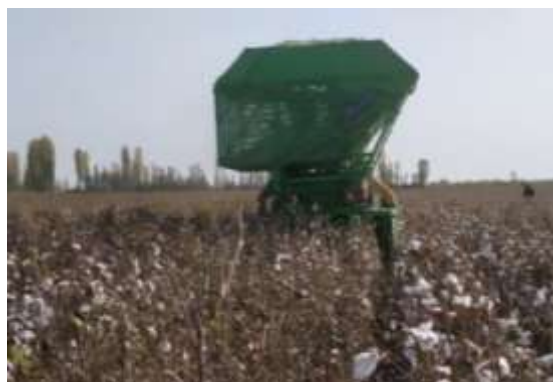
3-расм. ТТЗ 80.11М тракторига ярим осма шаклида агрегатланган ҳамда такомиллаштирилган ҳаво транспорт тизими билан жиҳозланган МХ-2,4 машинаси
