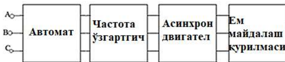
1-расм. Ем майдалаш қурилмасининг асинхрон моторини частота ўзгартгич қурилмаси орқали бошқариш схемаси
