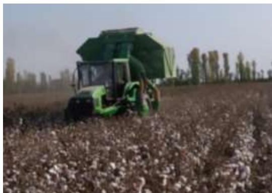
3-расм. ТТЗ 80.11М тракторига ярим осма шаклида агрегатланган ҳамда такомиллаштирилган ҳаво транспорт тизими билан жиҳозланган МХ-2,4 машинаси
