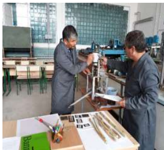
1-расм. С.В. Мельников қурилмасида маккажўхори поясининг қирқилиш жараёнини ўрганиш
