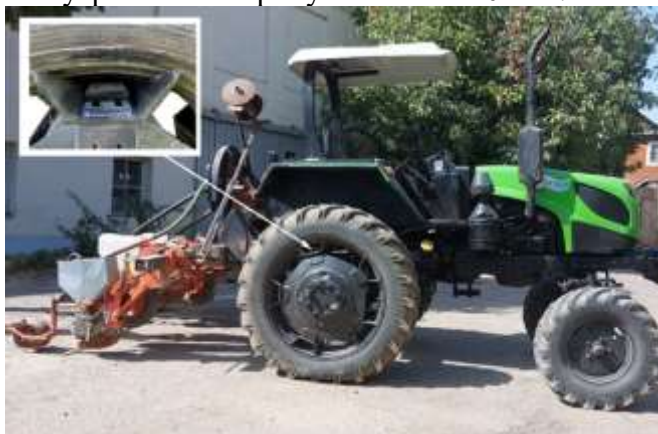
Рис. 2. Экспериментальный трактор, снабженный устройством для адаптации колеи задних колес на междурядья
