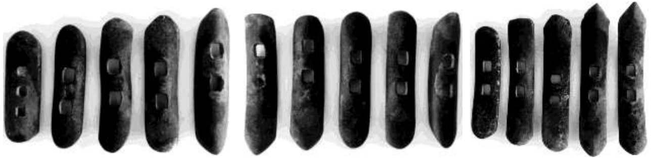
Рис. 2. Характер износа оборотных лап чизелей
