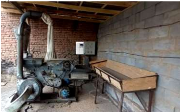
1-расм. Универсал ем майдалаш қурилмасининг асинхрон моторини частота ўзгартгич орқали ишга туширишнинг умумий кўриниши
