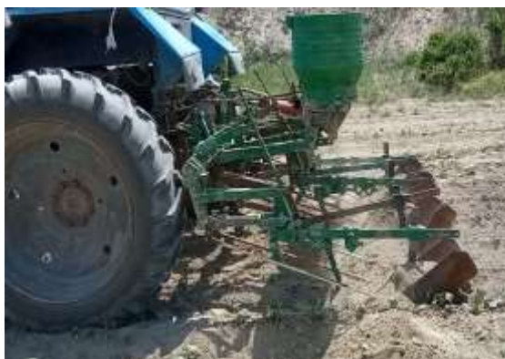
2-расм. Кўндаланг пол оладиган мослама билан жиҳозланган култиваторнинг иш жараёнидаги кўриниши
