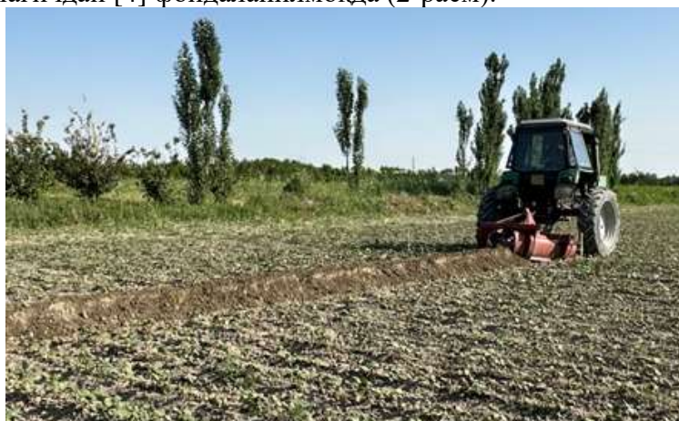
2-расм. КЗУ-0,3Д каналқозгич-текислагич қурилмаси билан кўндаланг тупроқ уюмини ҳосил қилиш жараёни
