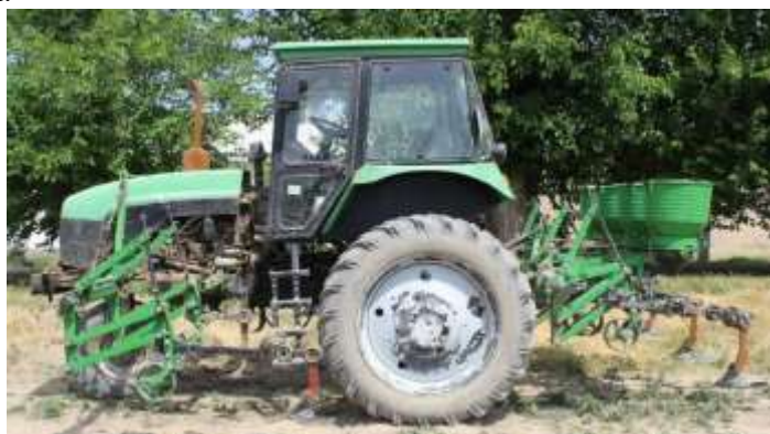
1-расм. Амалиётда фойдаланилаётган КРХ-3,6 култиваторини тракторга агрегатланиш схемаси
