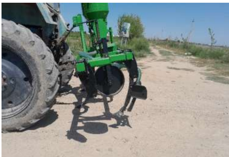
2-расм. Анор қатор ораларини тупроқларини чуқур юмшатадиган ва илдизларини кесадиган, ўғитни чуқур соладиган машинанинг тажриба нусхаси
