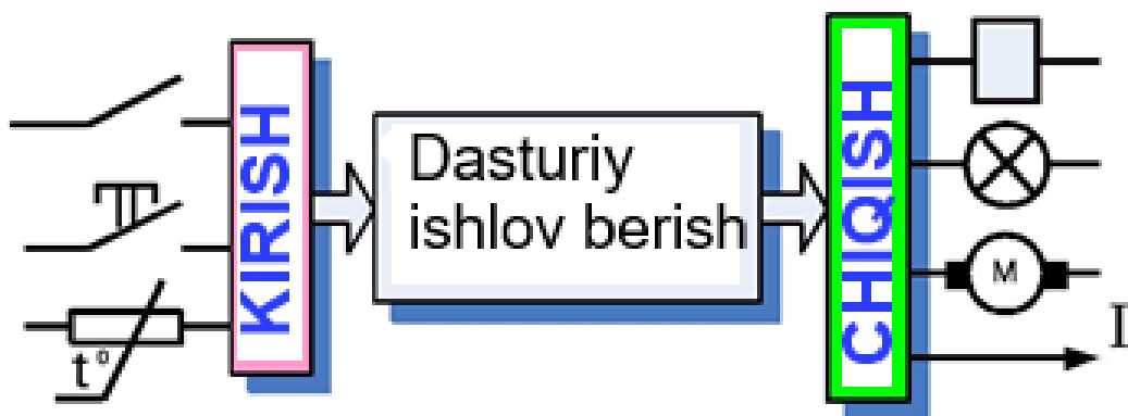
2.4-rasm. Kontrollerni sxemasi
