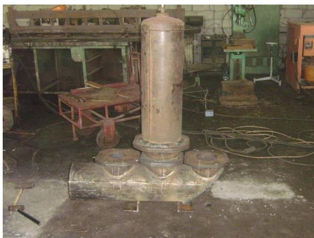
Рис. 43. Производство гидротарана
