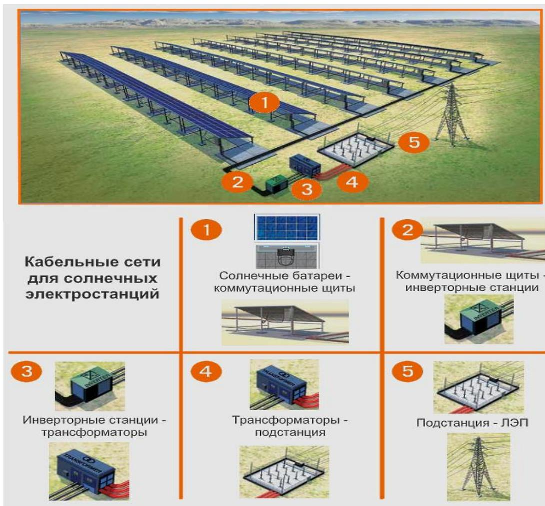
Рис.17. Сетевая солнечная фотоэлектрическая система
