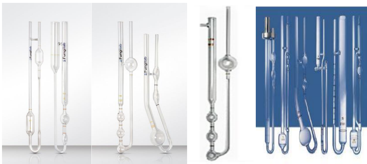
Shaffof suyuqliklar uchun kapillyar viskozimetrlari U-simon BS / IP / RF va Cannon-Fenske Routine turlarining umumiy ko‘rinishi
