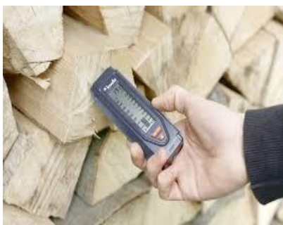
4.12 - rasm. Namlikni o'lchash asboblari: a) yog'och, b) sement s) g'alla
