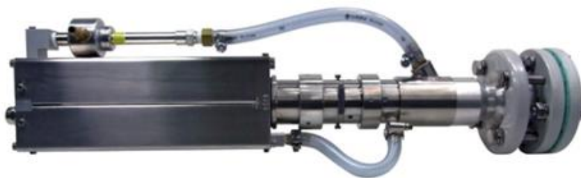
Alanga haroratini o'lchash uchun IPE 140/39 pirometr bilan FFTM o'lchov tizimini umumiy ko'rinishi
