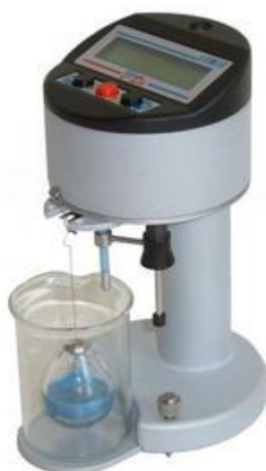
3.34-rasm. Laboratoriya sharoitiga moslangan Dendi raqamli zichlik o'lhagichi
