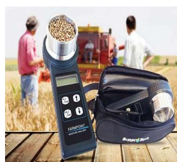
4.12 - rasm. Namlikni o'lchash asboblari: a) yog'och, b) sement s) g'alla
