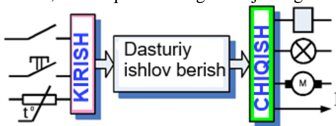
4.12-rasm. Kontrollerni sxemasi
