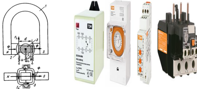
5.2 – rasm. Magnitoelektrik rele sxemasi va umumiy ko‘rinishi F_E kuchlari hosil qilgan moment,
