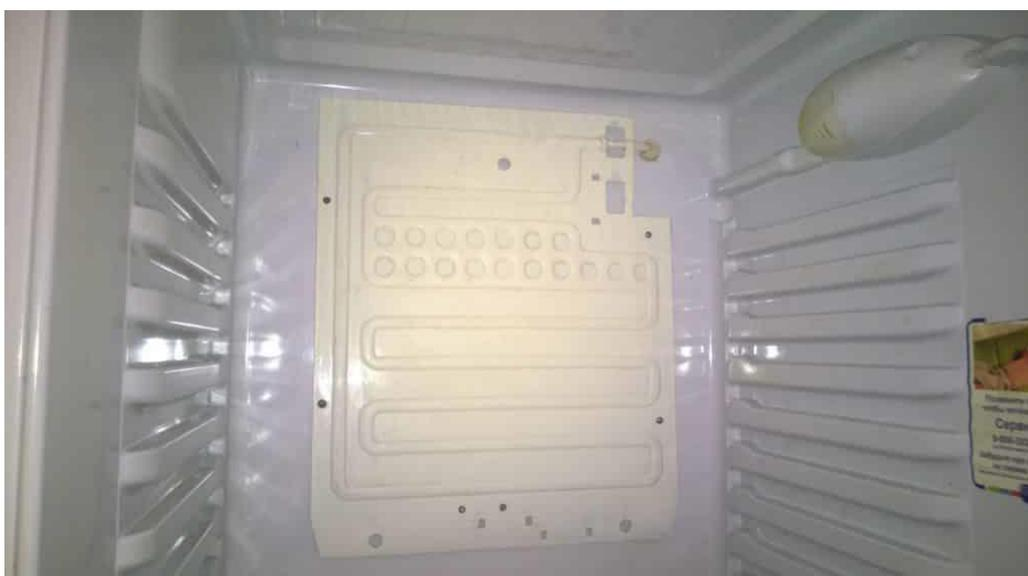
*Рис. 2.35. Общий вид испарителя*
