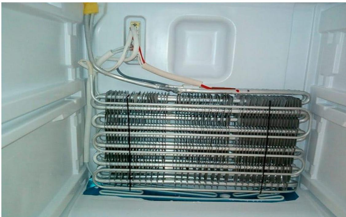
*Рис. 2.34. Общий вид испарителя*
