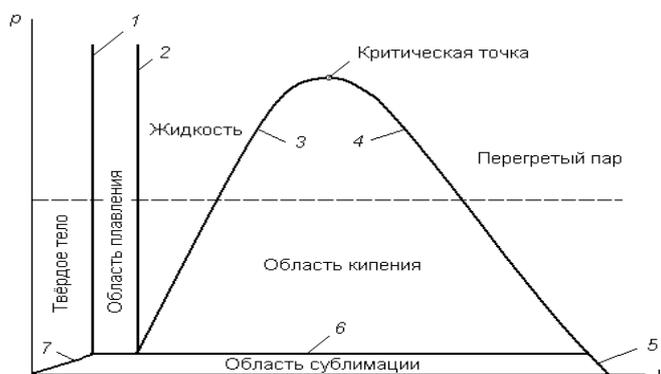
Рис. 1.10 -  $p-v$ -диаграмма агрегатных состояний охладителя ( $T=const$ )
