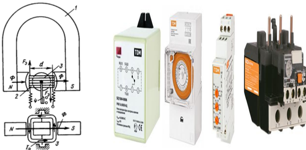
1.13 – rasm. Magnitoelektrik rele sxemasi va umumiy koʻrinishi
