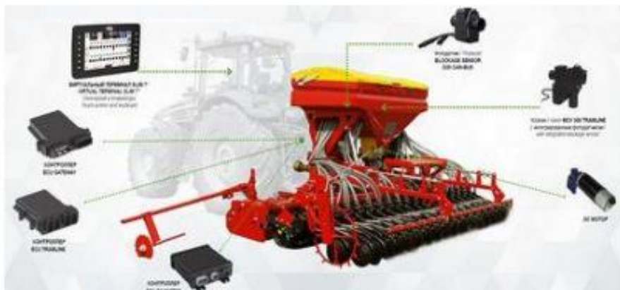
Рисунок 6. Система автоматизации рядовых сеялок USC
