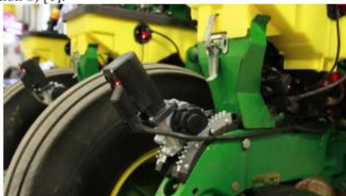
Рисунок 8. Автоматическая система контроля глубины посева «Smart Depth»
