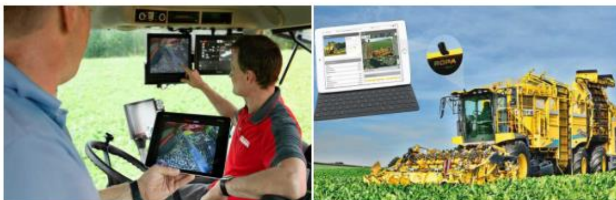
Рисунок 9. Система цифровых камер «Smart View»
