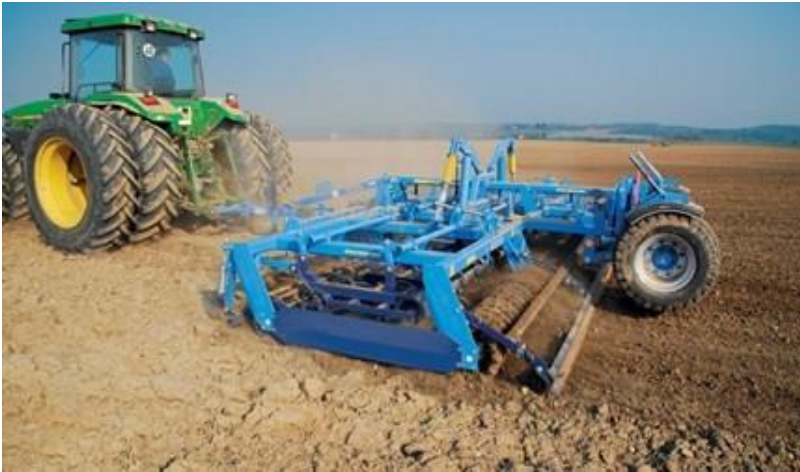
1.9-расм. Шудгорланган ерларга экиш олдидан ишлов беришда қўлланиладиган комбинатор
