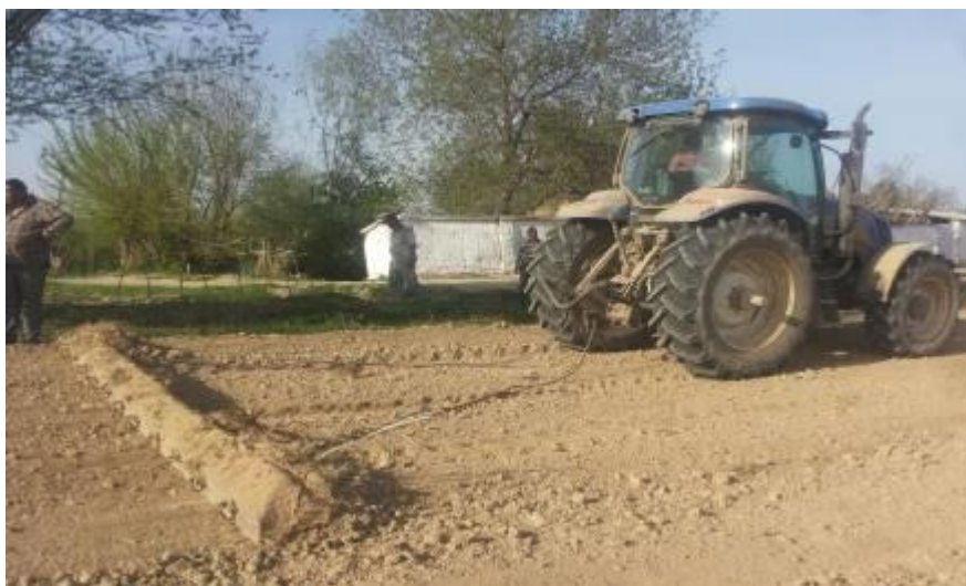
1.4-расм. Бетон брус (симёғоч)дан тайёрланган ясама мола-текислагич
