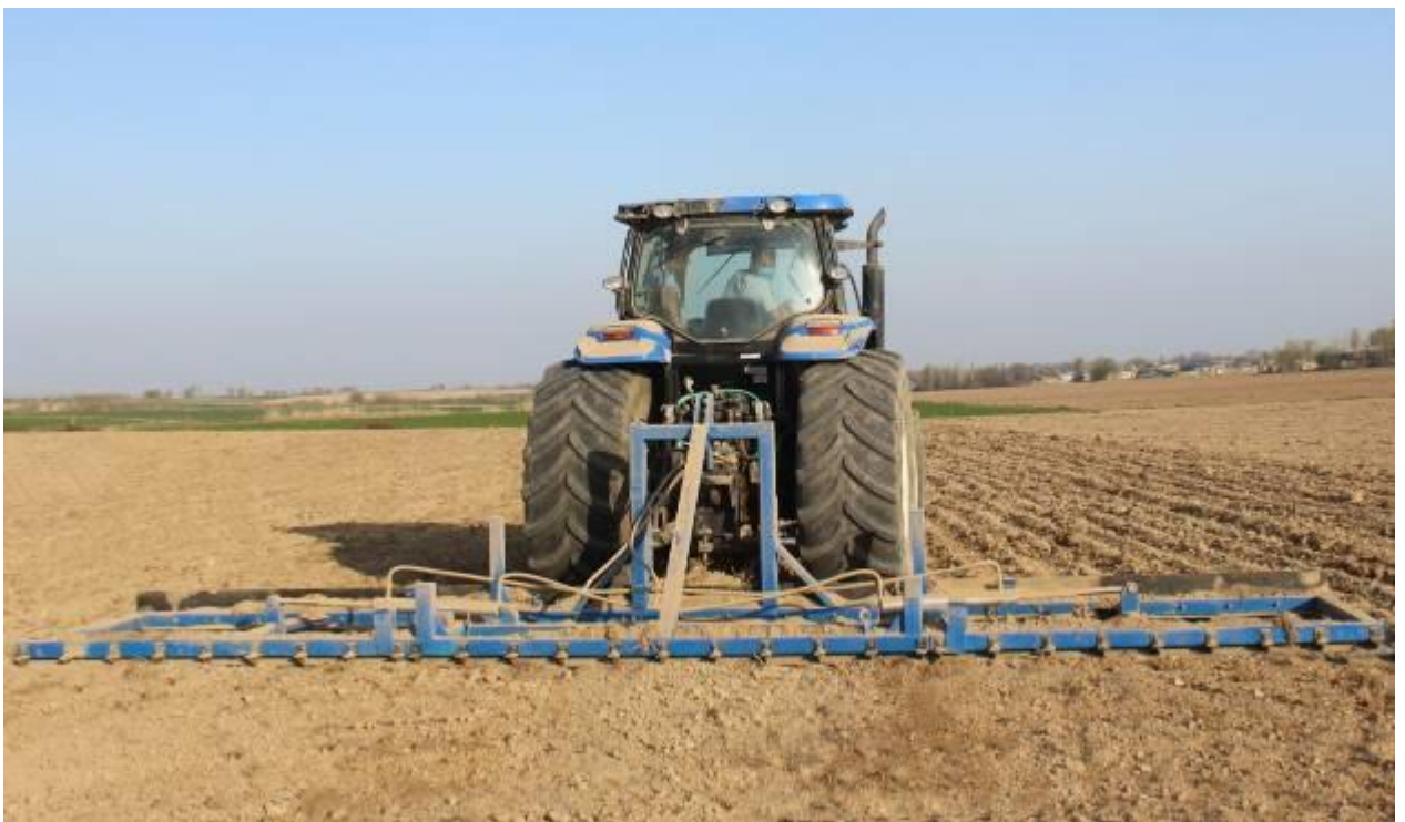
4.4-расм. Такомиллаштирилган мола-текислагич тажриба нусхасининг иш жараёндаги кўринишлари
