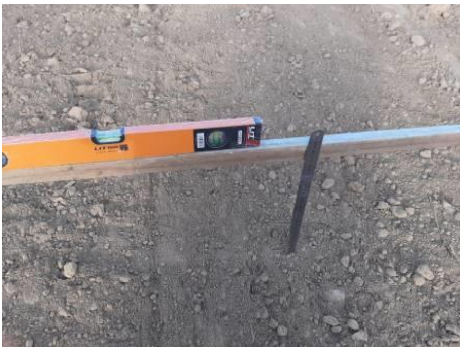
3.4-расм. Мола-текислагич ўтгандан кейин дала юзасининг профилини олиш
