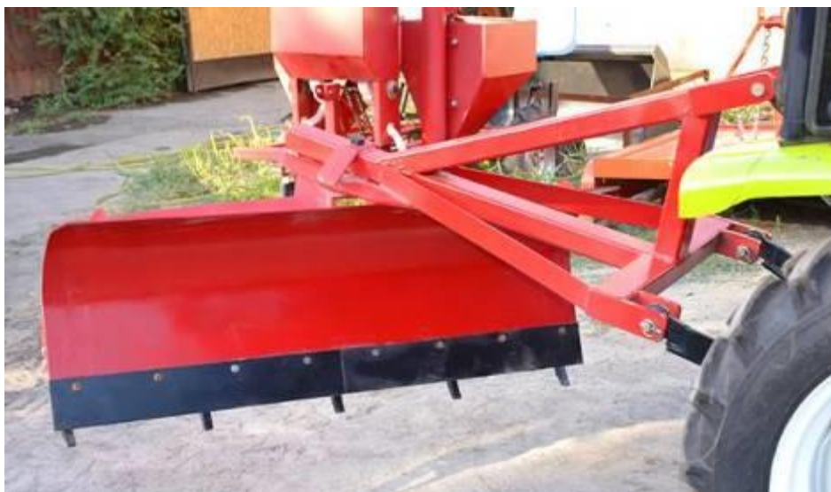
1.7-расм. RGBR-5FT моделдаги ер текислагич
