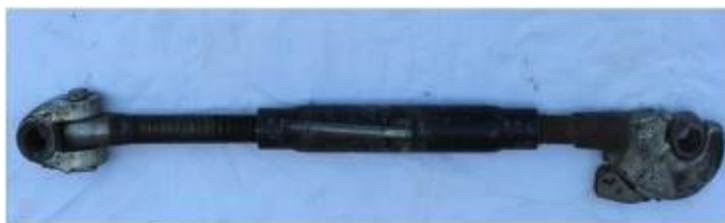
3.14-расм. Трактор осиш механизмининг узайтирилган марказий тортқиси
