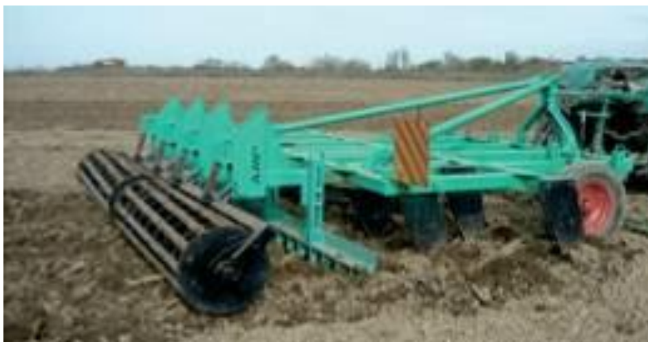
1.6-расм. Ерларни текислайдиган РВП-4 русумли қурилма
