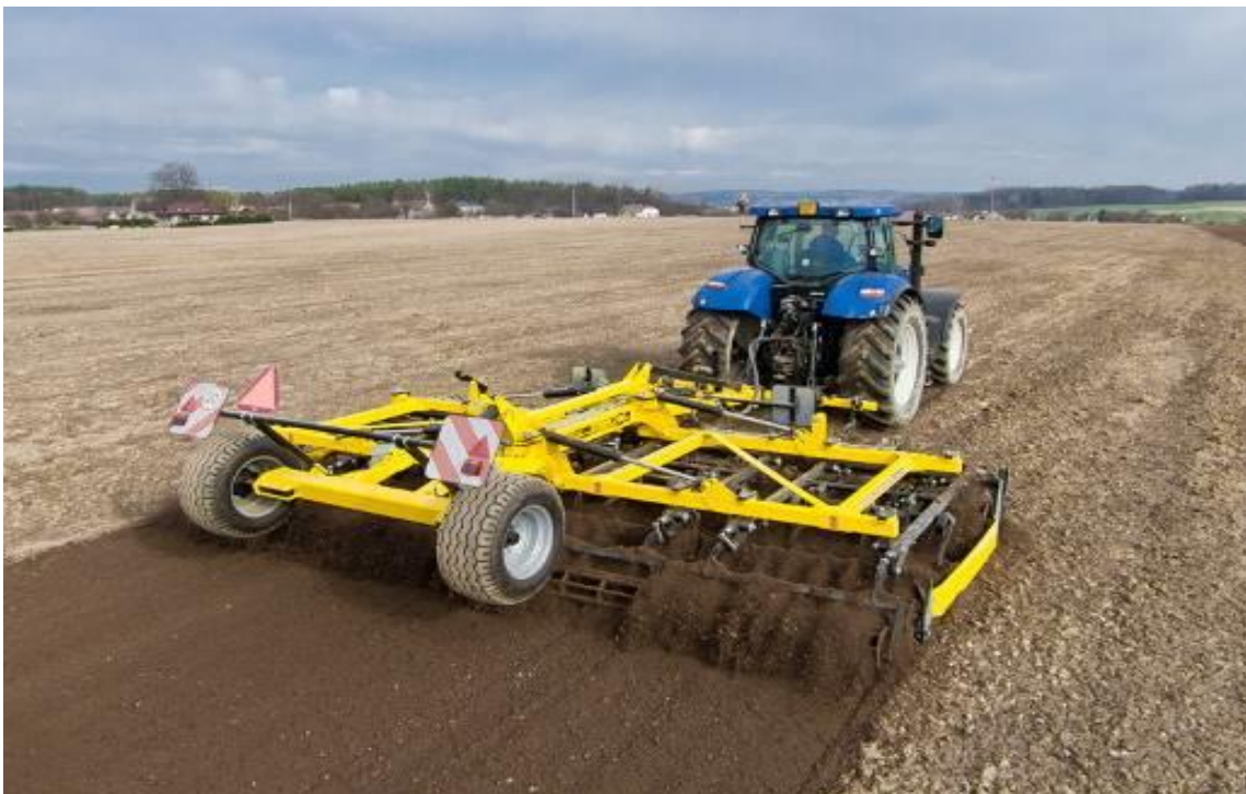
1.10-расм. Тупроқ шароити оғир бўлган ерларни экишга тайёрлашда қўлланиладиган компактор
