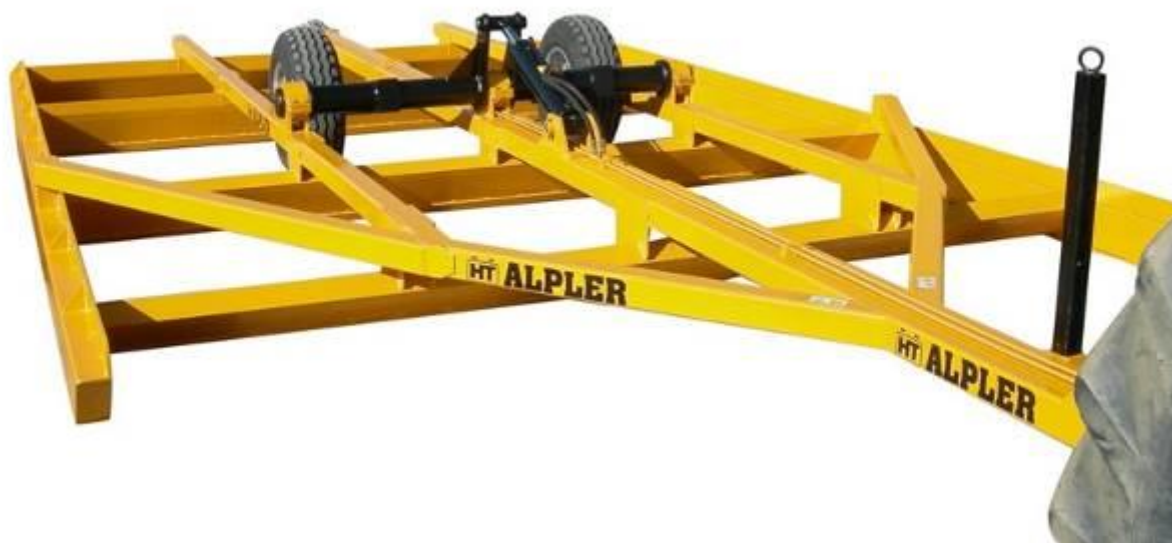
1.14-расм. Alpler русумли текислагич-зичлагич қурилмаси
