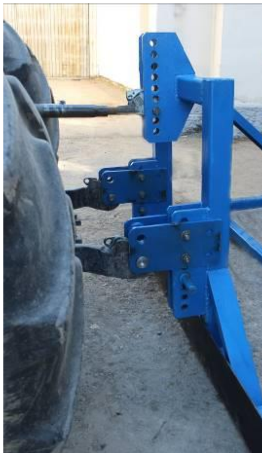
3.16-рам. Трактор осиш механизми пастки тортқисининг қурилмага уланиш нуқтасини олдинга олиб чиқилган ҳолатдаги кўриниши
