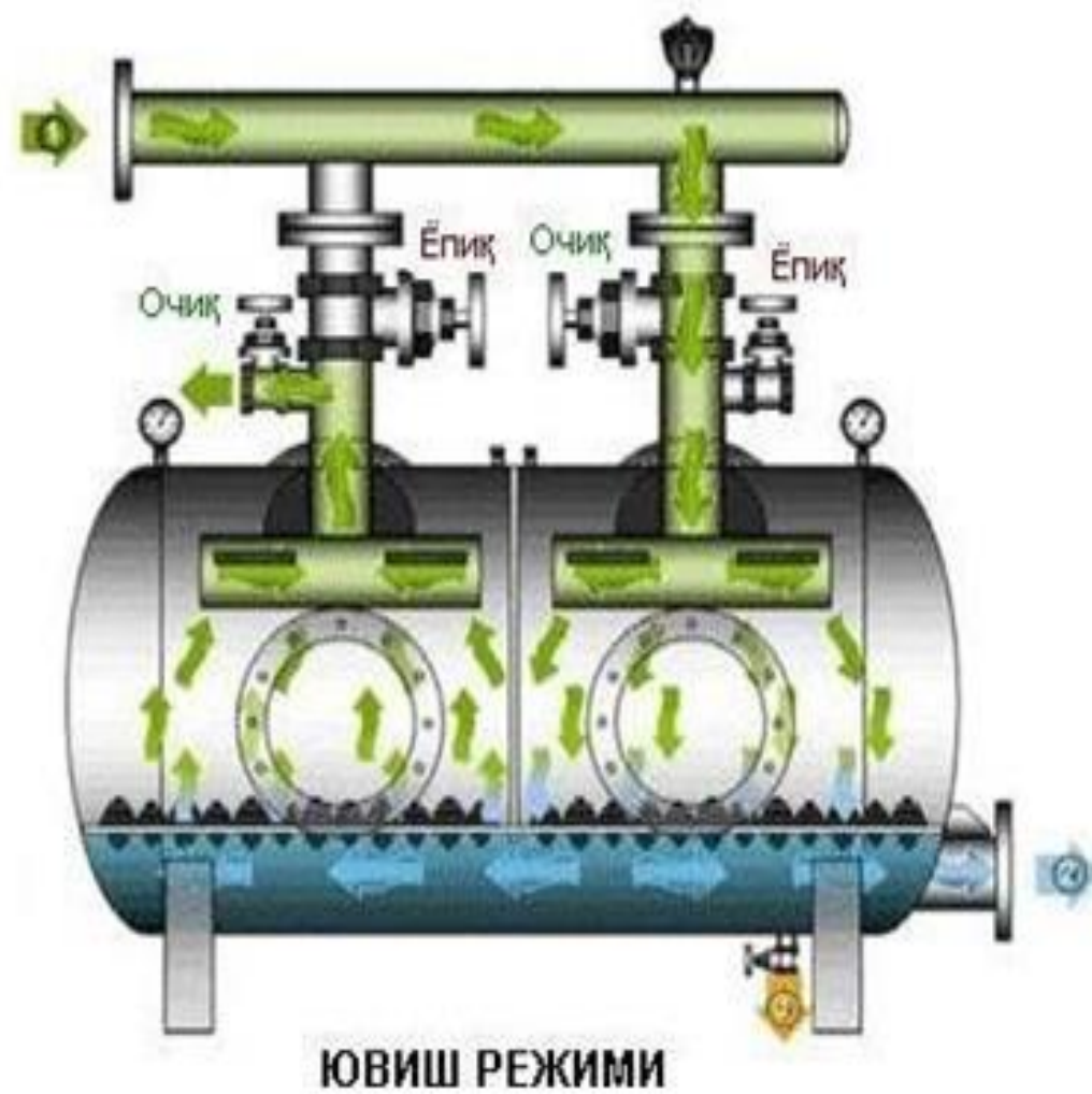
Ikki kamerali qumli filtrning ishlash va yuvish rejimlari
