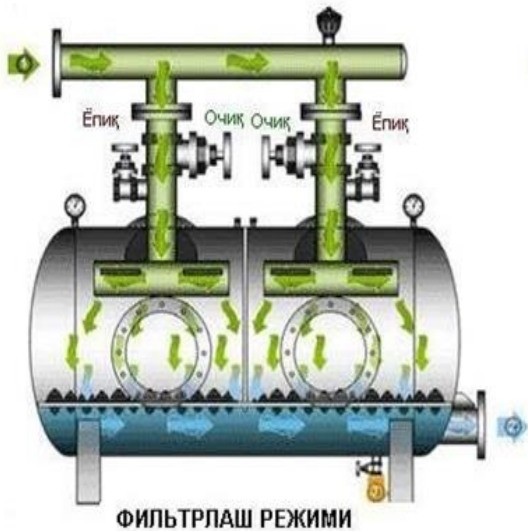
Ikki kamerali qumli filtrning ishlash va yuvish rejimlari
