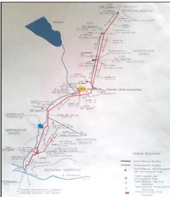
2-rasm. Zarafshon daryosidan Jizzax viloyatidagi loyihalashtirilayotgan zonalarga toza ichimlik suvi yetkazib berish sxemasi
