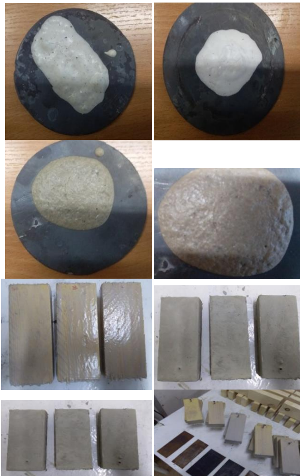
2 -расм. Янги лак бўёк таркиблари ва улар асосида ҳар хил юзаликлардаги юзага келган қопламалар
