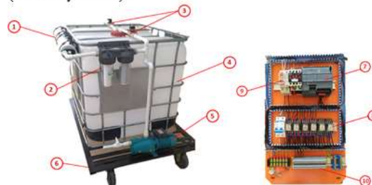
Рисунок 3 Прототип устройства очистки оросительной воды от высокого соледержания
