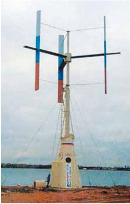
Рис. 6. Ветроэнергетическая установка с ортогональными лопастями, предназначенная для размещения на плотине ПЭС
