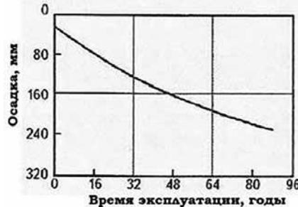
**Рис. 5.** Интенсивность увеличения осадок ложа водохранилища СШГЭС после наполнения в 1990 г.
