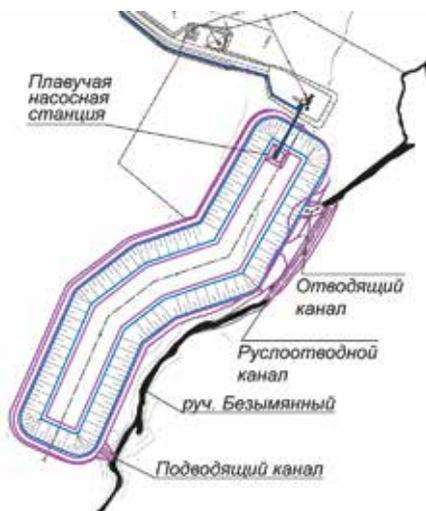
Рис. 2. Ковшовый водозабор
