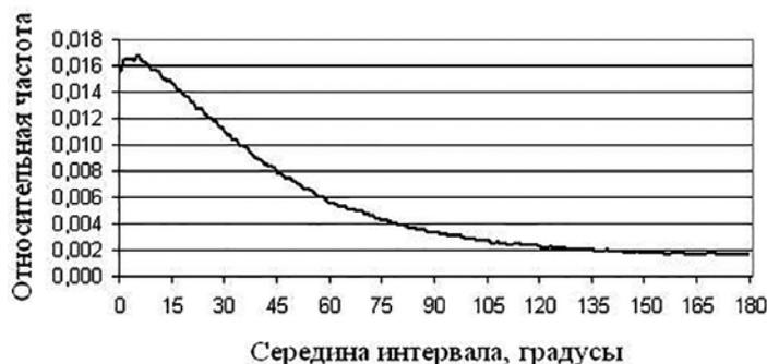
Рис. 5. Распределение модуля последовательных разностей COG GPS-приемника GP-37
