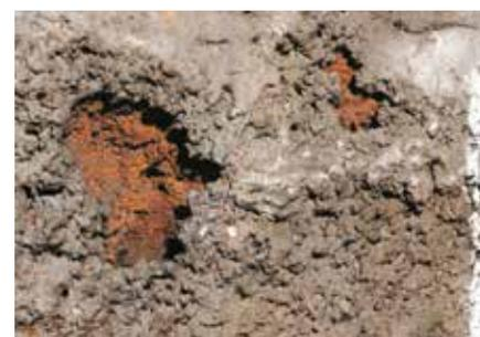
**Рис. 7.** Кавитационные разрушения нержавеющей наплавки и основного металла камеры
