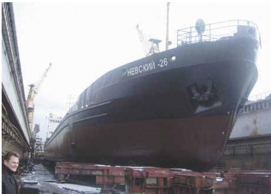
Рис. 3. Ремонтная окраска судна
