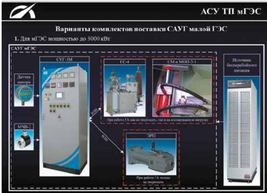
Рис. 1. Структурная схема САУГ малой ГЭС
