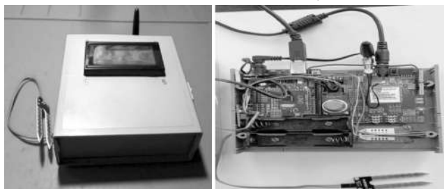
Рис. 3. Общий вид лабораторного прототипа интеллектуальной системы мониторинга процесса полива на основе IoT
