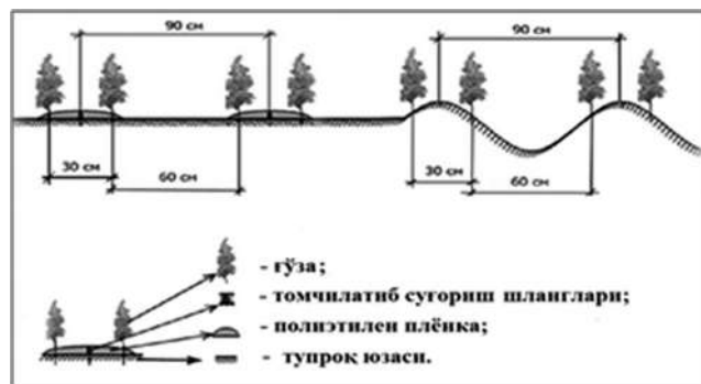
1-расм. Қўшқаторлаб экилган ғўзани плёнка остидан томчилатиб суғориш схемаси.
