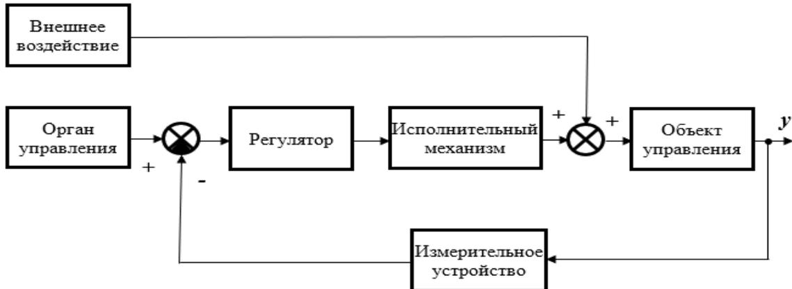
Рисунок 1- Система автоматического управления объектом
