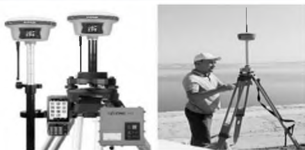
2-расм. Маълумотни қабул қилувчи АУПНТ ускунасини сунъий йўлдошга улаш ҳолати.
