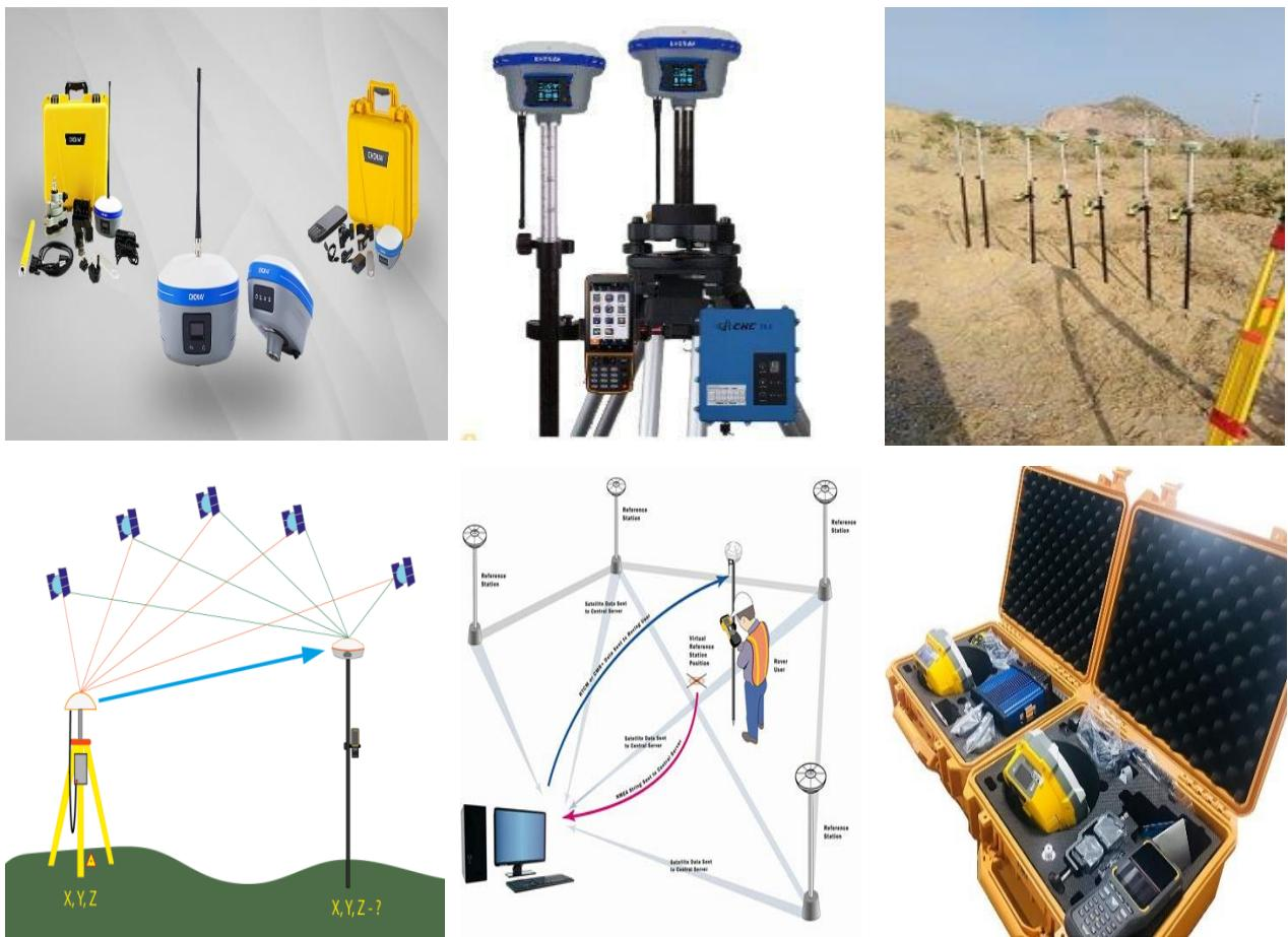
**2.25-расм. iBase GNSS ва i73 GNSS қабул қилувчи ўлчаш воситасининг кўриниши**
