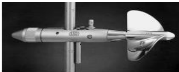
Рис. 7. Универсальный ИСП С-31 (материалы винта: Л – латунь, П – пластик, А – анодированный алюминий, ОТТ-Hydrometrie, г. Кемптен, Германия) (по [18])
