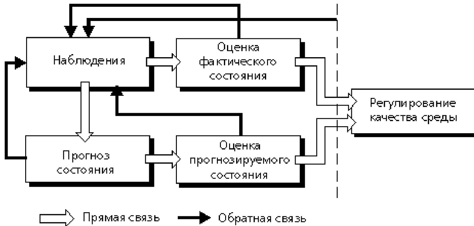
*Блок-схема системы мониторинга*
