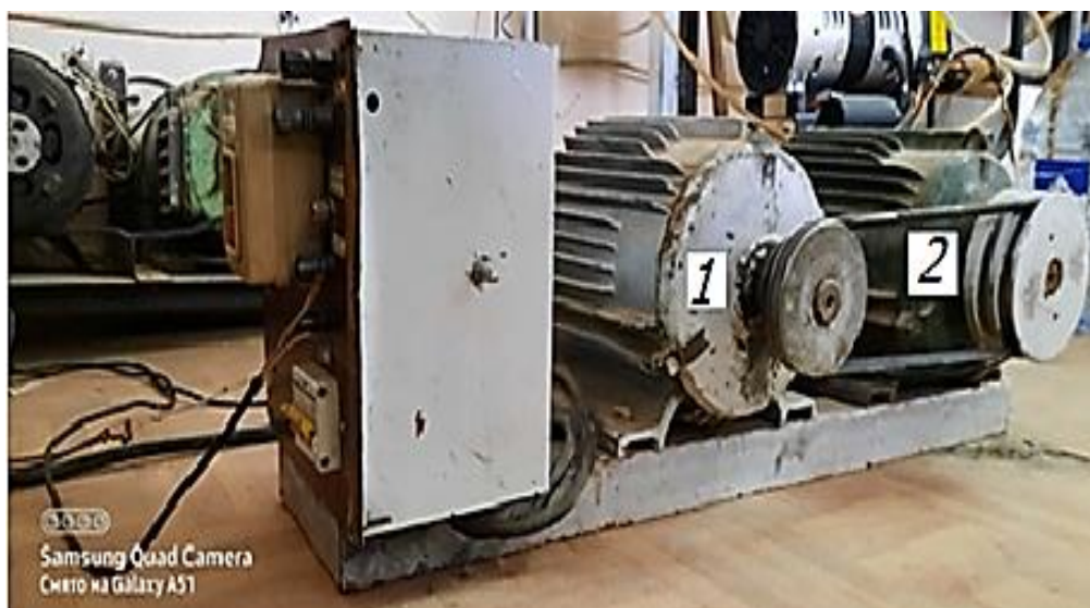
Рис.4.11. Генератор периодических импульсов напряжения (1), приводной двигатель (2), пульт управления (3)
