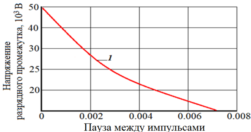
Рис. 2.4. Характеристика изменения напряжения разрядного промежутка в паузе между импульсами: 1 - C_{np} = 10^{-9} Ф
