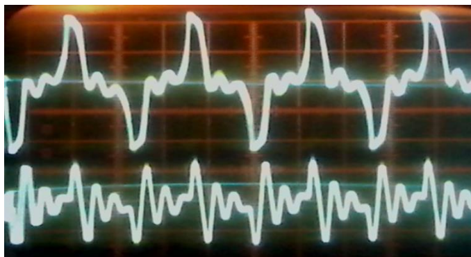
Рис. 3.15. Осциллограмма периодического импульса напряжения (верхняя) и тока (нижняя) при подключен параллельно генератору озона конденсатора (развертка 0.01 с/см)
