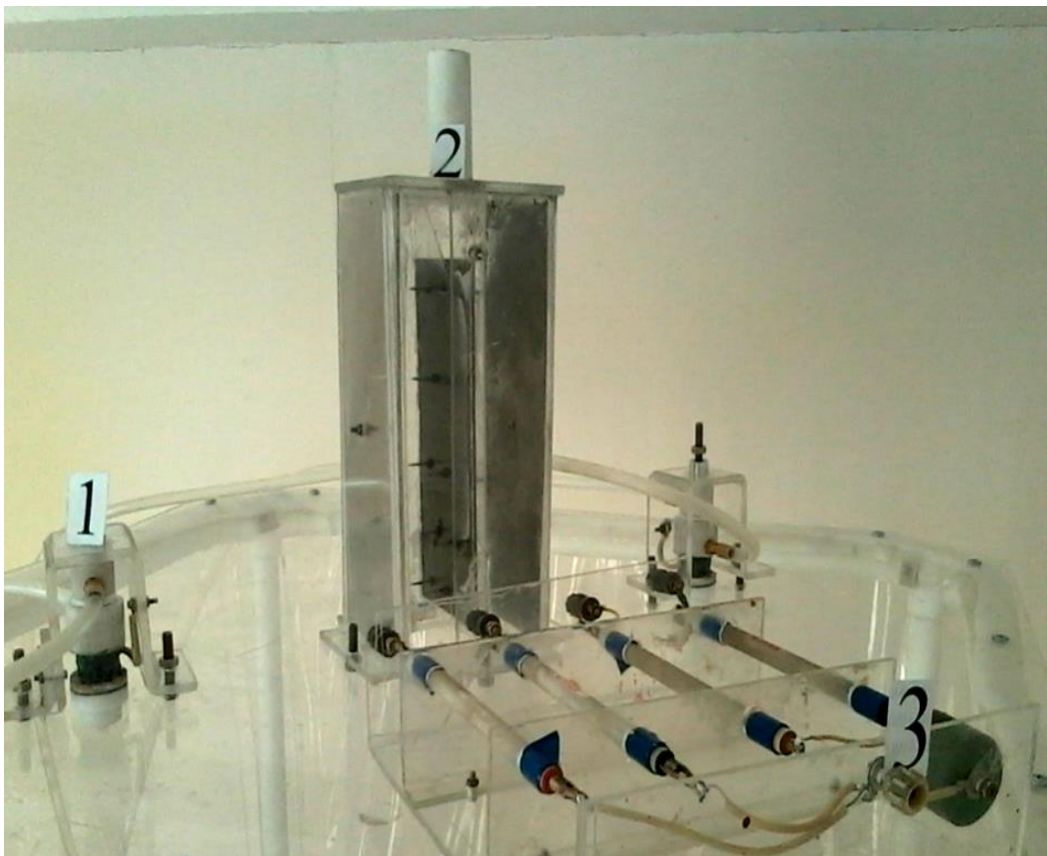
Рис. 4.10. Оборудование установленной на крышке контактной камеры 1-пневмоэлектростатический распылитель; 2- сепаратор аэрозоля; 3 – блок выпрямителей .
