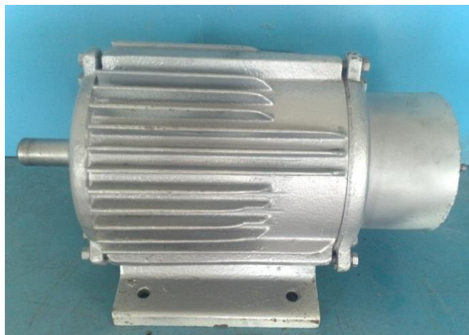
Рис. 3.4. Машинный генератор периодических импульсов высокого напряжения
