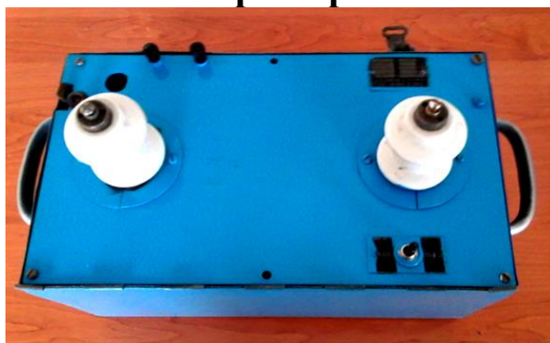
Рис. 4.15. Трансформатор с входным напряжением 100/220 В и двумя отдельными выводами по 10 кВ
