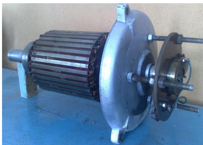
Рис. 3.6. Ротор генератора с щеточным механизмом питания обмотки возбуждения
