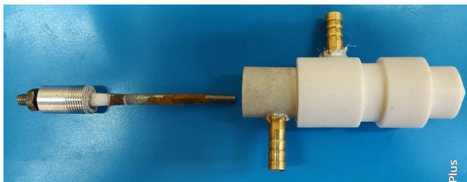
Рис. 4.5. Общий вид электростатического распылителя водной аэрозоли
