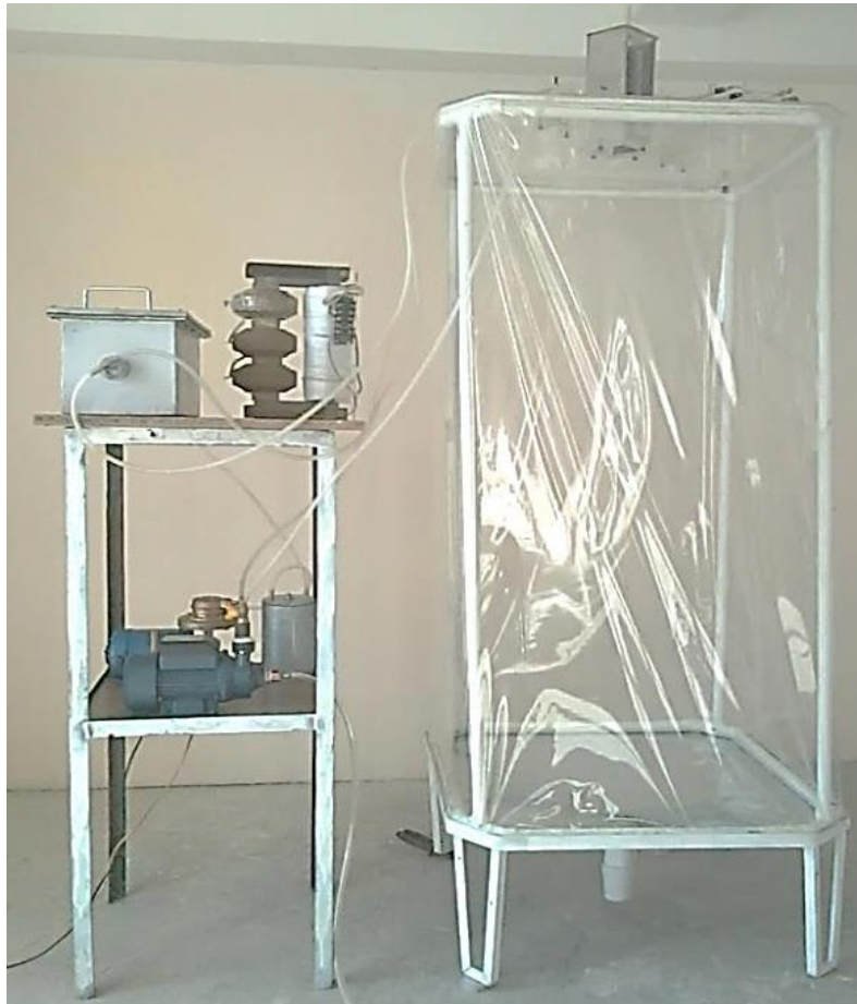
Рис. 4.7.Общий вид экспериментальной установки для проточной обработки воды озоном
