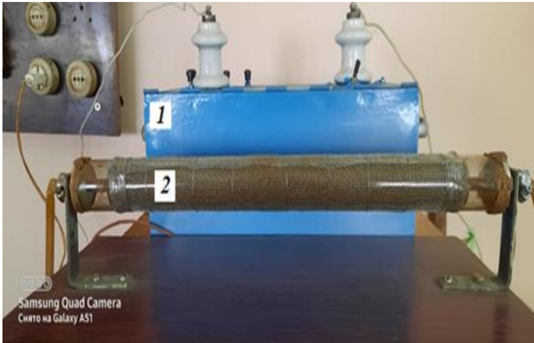
Рис. 4.9. Оборудование верхней полки стеллажа 1- повышающий трансформатор; 2-генератор озона.
