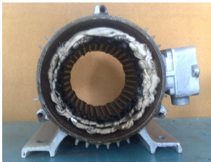
Рис. 3.5. Статор генератора периодических импульсов напряжения
