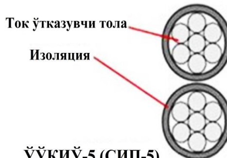
Расм - 2.4. Ўз-ўзини қўтарувчи изоляцияланган симни қуриш: ЎЎҚИЎ-1; ЎЎҚИЎ-2; ЎЎҚИЎ-3; ЎЎҚИЎ-4; ЎЎҚИЎ-5
