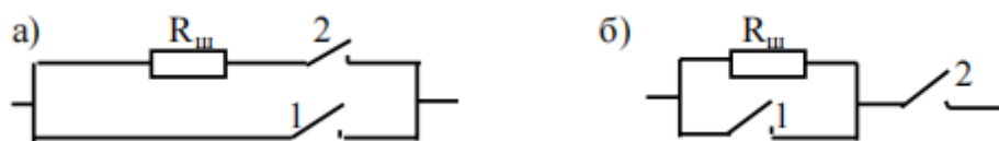
Анжир. 2.29. Параллел а) ва серияли-параллел б) ўчиргичнинг электрон дизайни (1) шунт қаршилиги R_{ш} ва қўшимча контактлар билан (2)
