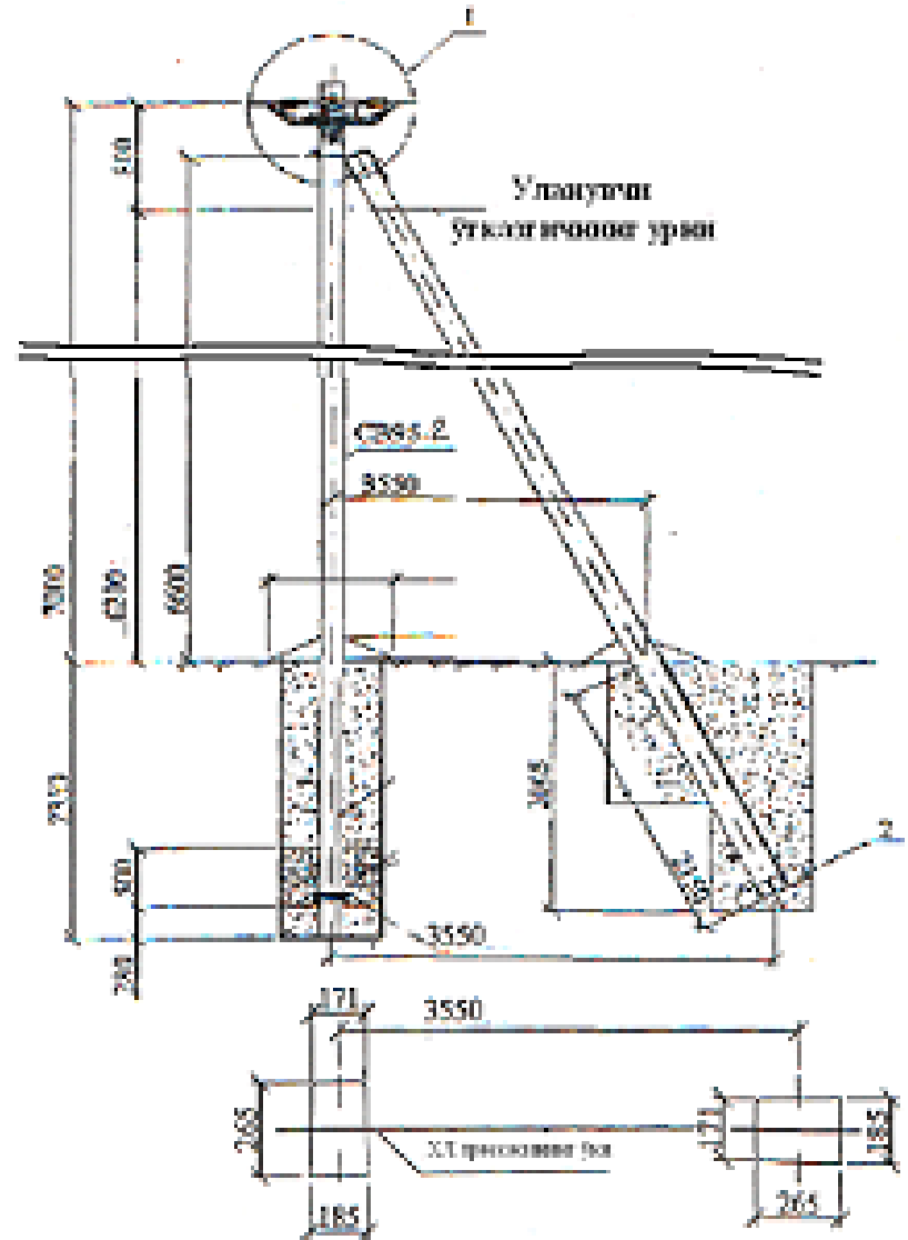
4.24 – rasm. Burchak oraliq sim ustuning joylashuvi va oʻlchamlari.
