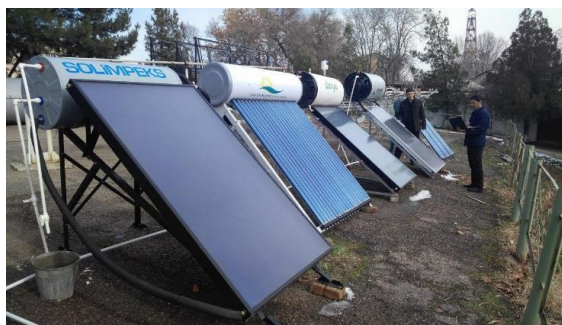
Рис. 2. Оборудование экспериментальных исследований, проводимых в натуральных условиях на Гелиополигоне по определению тепловой эффективности СВУ ФТИ АН РУз (2017-2021 гг.)
