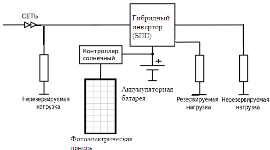
Рис.2 Принципиальная схема соединенной с сетью аккумуляторной ФЭС.
