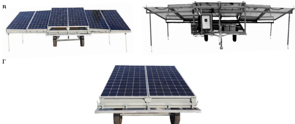
Рис.1. Продолжение Общий вид ГМСТЭ в развернутом состоянии (а) фронтальной и тыльной (б) стороны, общий вид в собранном (в) состоянии гибридной мобильной солнечно-топливной электростанции с автоматизированным управлением режимами энергопотребления [6]
