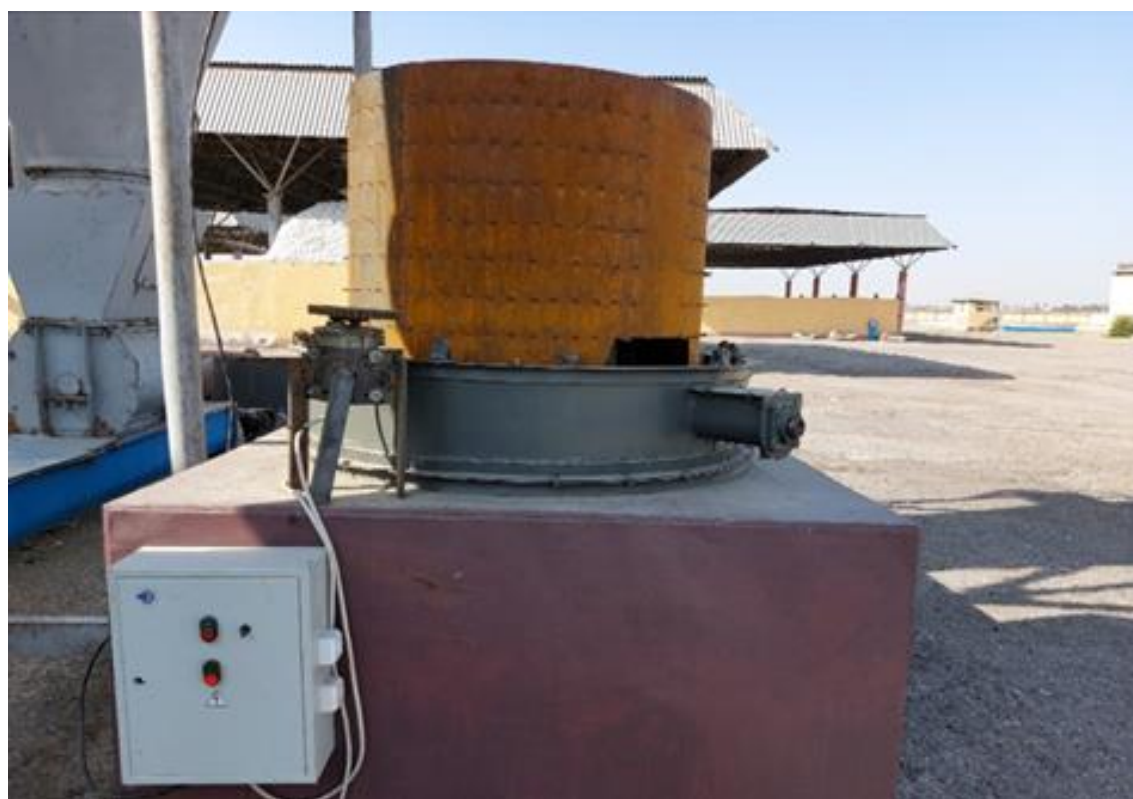
4.10-расм. Бошқарув пулти ва тож разряд ҳосил қилувчи барабанлари билан электр фильтрнинг асоси ўрнатилган ҳавони тақсимлаш бункери
