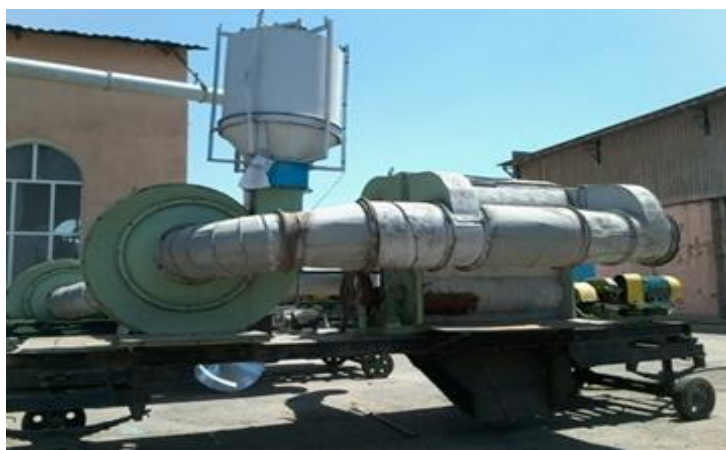
1.10 -расм. Электр фильтрнинг СС-15А сепараторга ўрнатилган кўриниши
