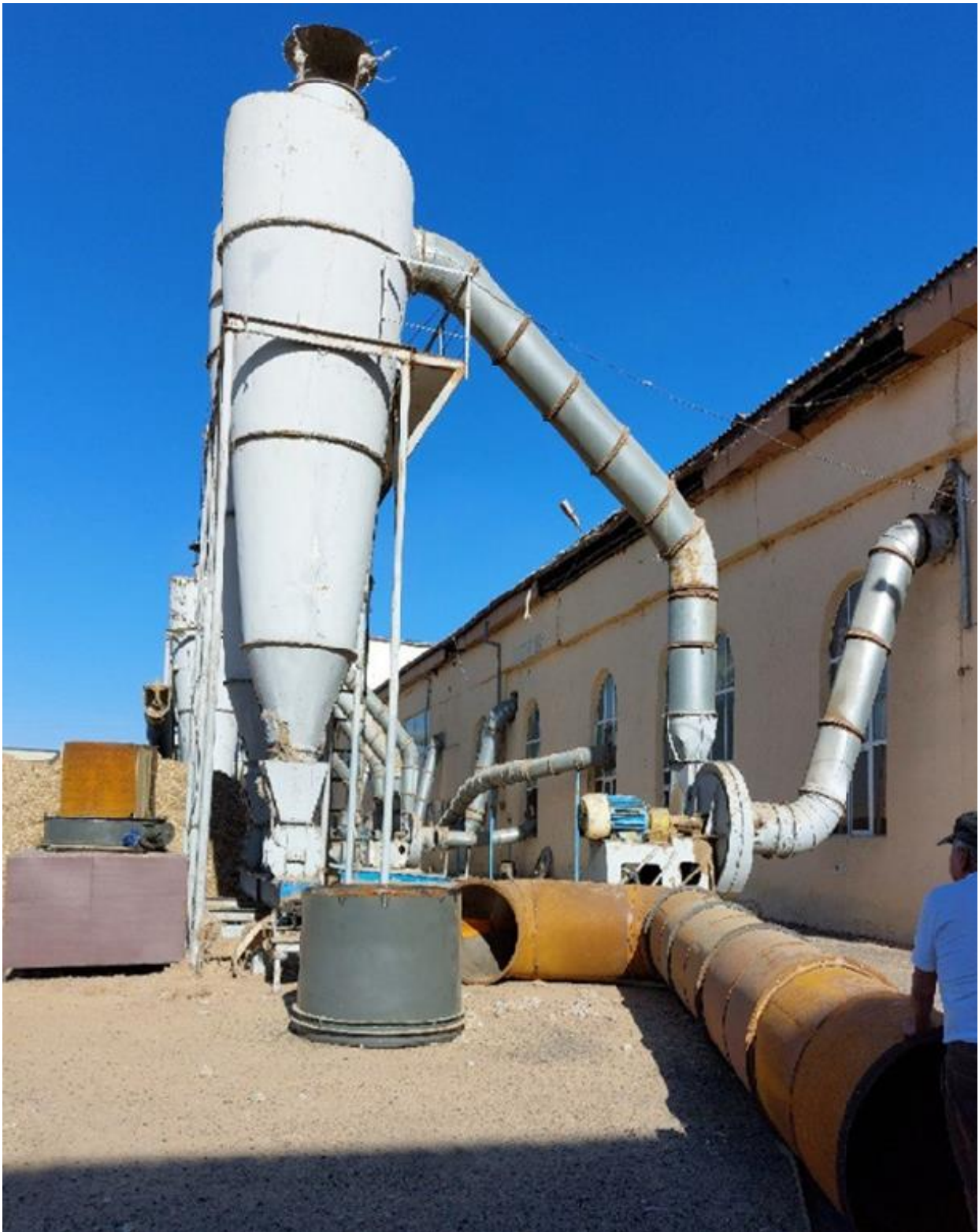
4.6-расм. Игна барабанлари, чанг бостириш барабанлари, хаво ўтказгичлари ва электр филтърнинг асоси ўрнатилган хавони тақсимлаш бункери
