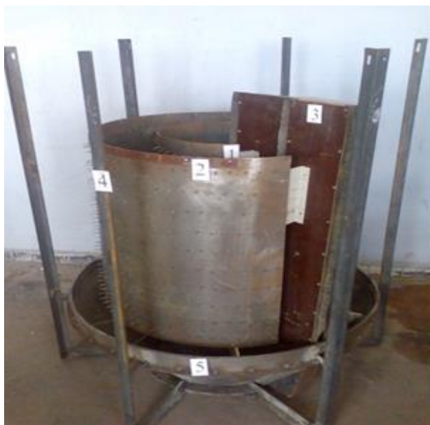
1.7-расм. Циклондан чиқишда ҳавони тозалаш учун электр фильтрнинг асоси
