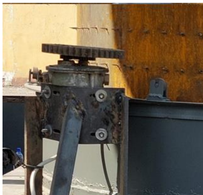
4.9-расм. Чанг бостирувчи барабанны айлантурувчи мотор-редуктор
