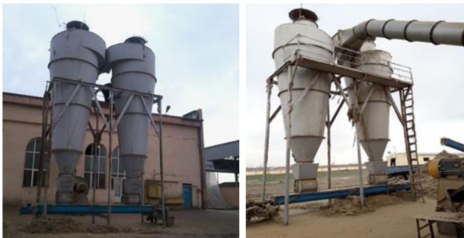
4.1- расм. Пахтани қуритиш ва тозалаш цехига етказиб бериш учун пневматранспорт тизимининг чиқиш жойига ўрнатилган қўш циклонларнинг умумий кўриниши.
