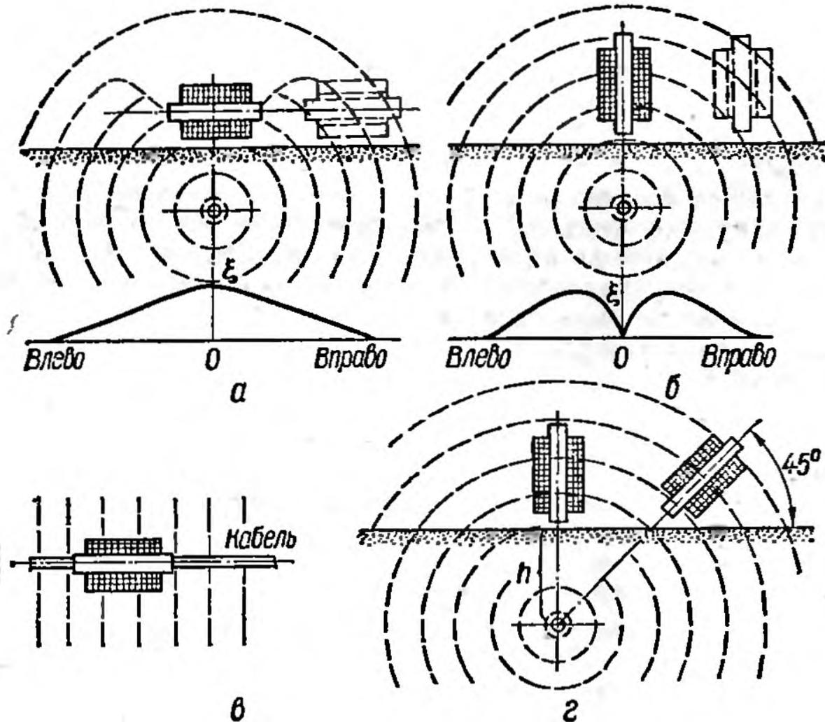
Принципиальные схемы определения места повреждения изоляции кабеля акустическим методом: *а* - схема с конденсатором; *б* - схема с использованием емкости неповрежденных жил; *в* - схема с заплывающим пробоем в муфте.
