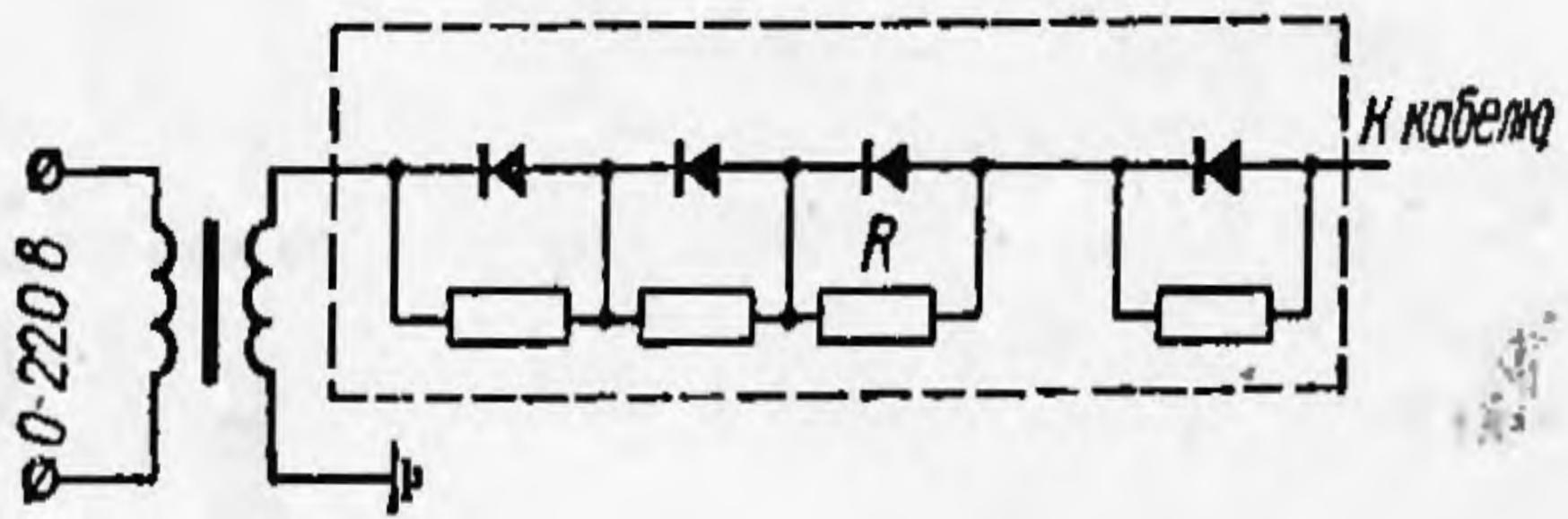
Схема прожигания поврежденной жилы кабеля резонансным трансформатором.
