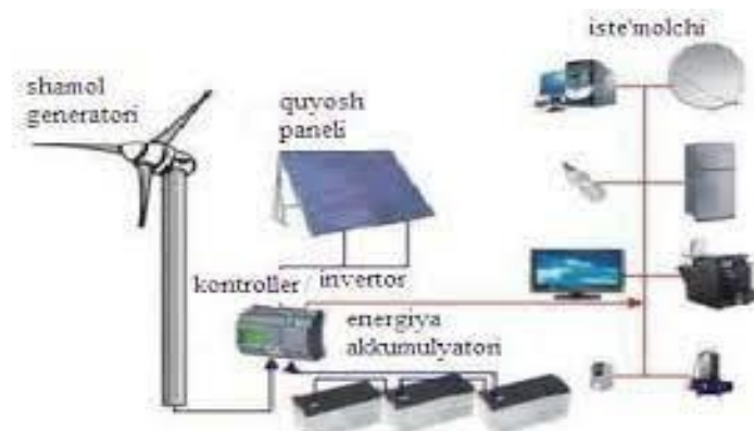
3-rasm. Shamol elektr va Quyosh elektr texnologiyalarini birlashtirgan Gibrid elektr tizimi.
