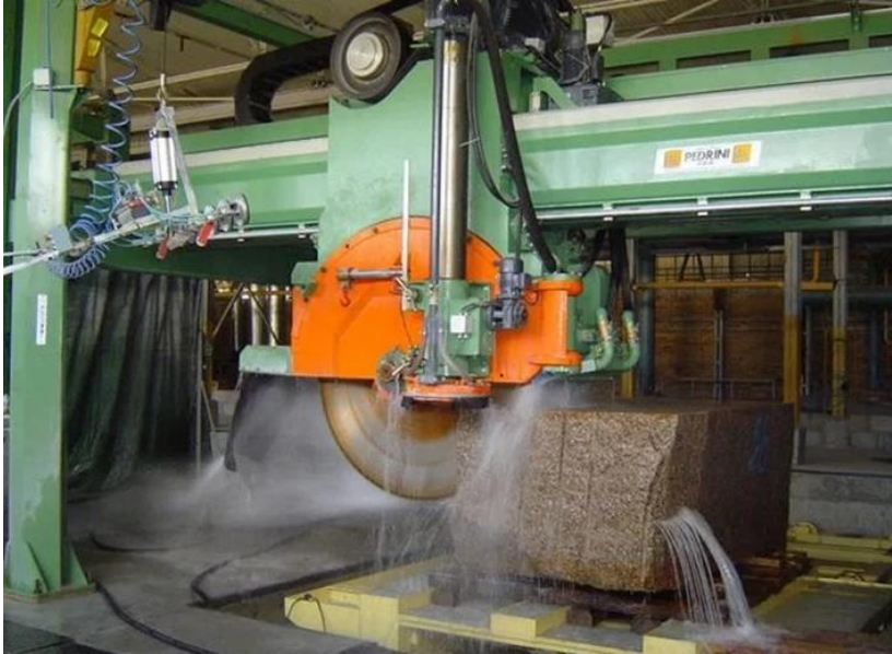
Рис.1. Водяное охлаждение дисковой пилы в процессе резки камня.
