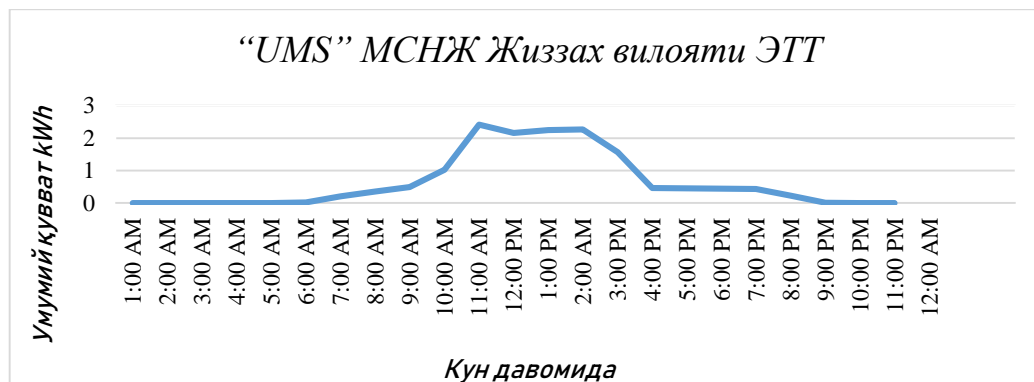
4.14-расм. “UMS” МСНЖ Жиззах вилояти филиали стационар энергия таъминоти манбаининг кун давомидаги маълумотлари
