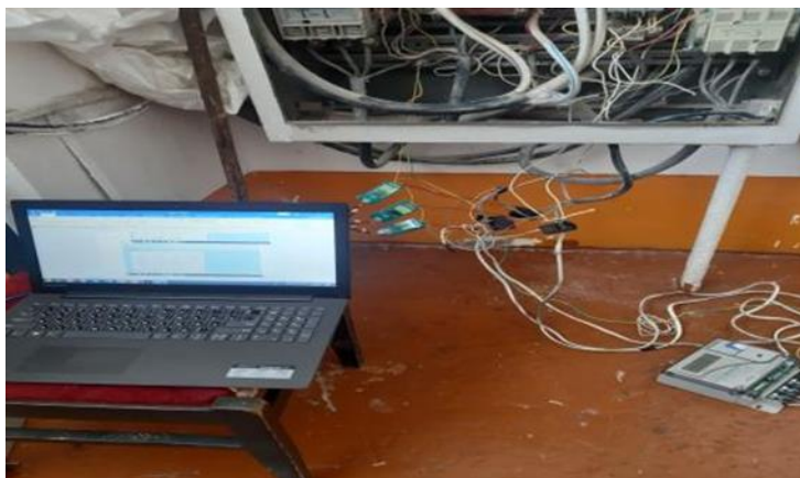
4.30-расм. Электр энергия истеъмолининг самарадорликни ўлчов-назорат қурилмасинг тажриба-синов жараёни
