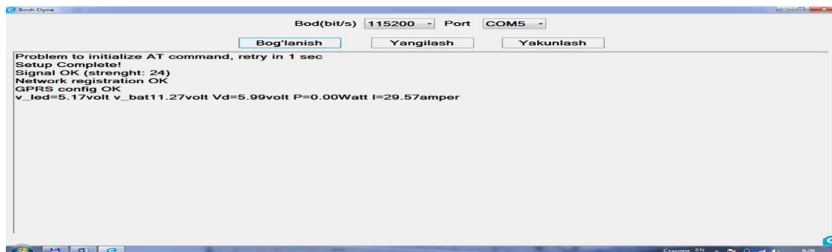
3.4-расм. Ўлчов ва назорат қурилмасини тармоққа уланиши
