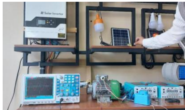
4.8-rasm Quyosh panellari ishlab chiqarayotgan bir fazali elektr energiya uzatish tarmog'idan ta'minlangan bir fazali bir va uch chulg'amli asinxron motor reaktiv quvvatini nazorat qilish va boshqaruvi uchun elektromagnit tok o'zgartkichi sinov stendi
