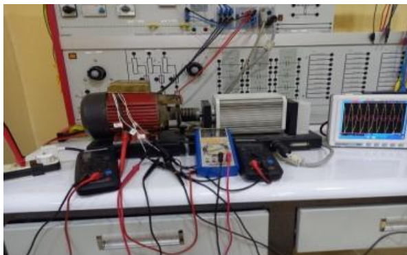
4.8-rasm Quyosh panellari ishlab chiqarayotgan bir fazali elektr energiya uzatish tarmog'idan ta'minlangan bir fazali bir va uch chulg'amli asinxron motor reaktiv quvvatini nazorat qilish va boshqaruvi uchun elektromagnit tok o'zgartkichi sinov stendi
