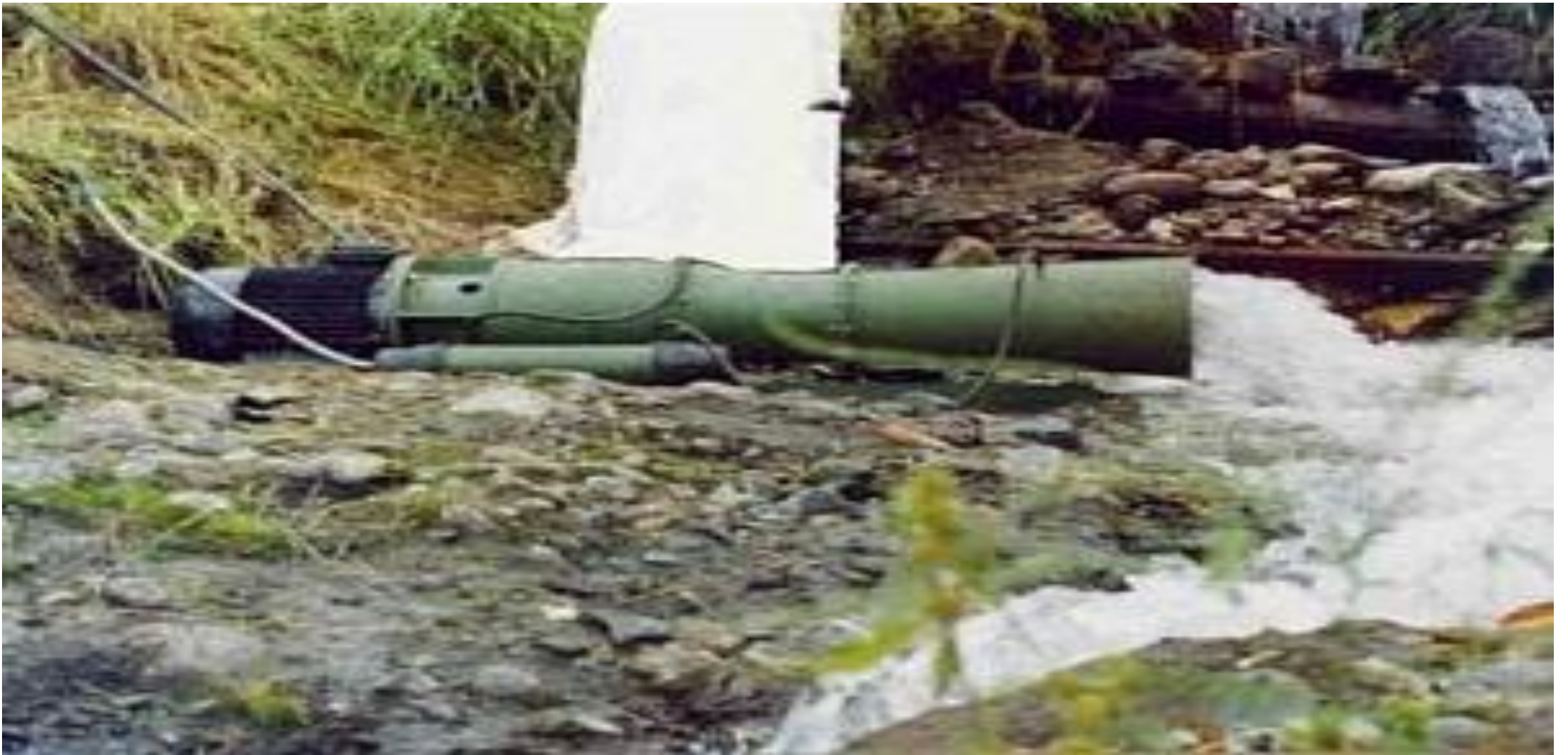
1.18 - rasm. Mikro 10 tipidagi quvvati 10 kVt li mikrogidroelektrostansiya
