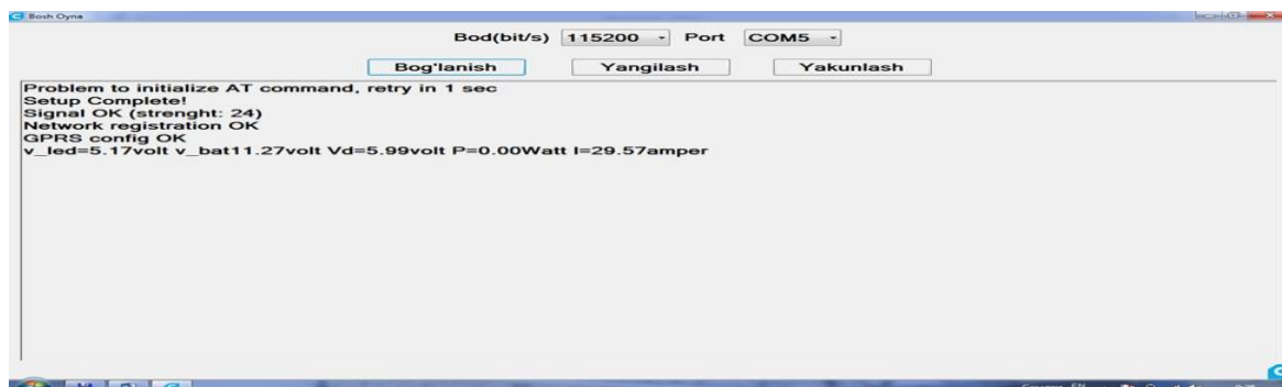
3.4-расм. Ўлчов ва назорат қурилмасини тармоққа уланиши
