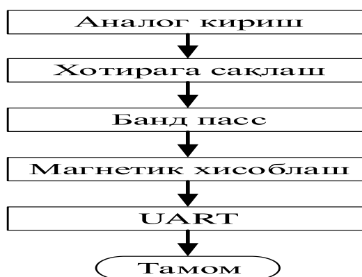
2.10-расм. Демодулятор блок диаграммаси
