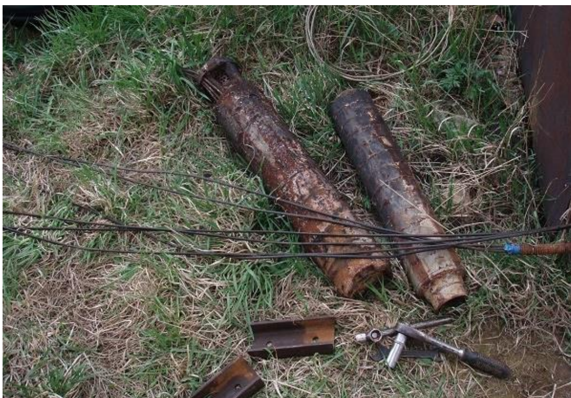
4.1 - расм. Актив менераллар ва туз даражаси юқори бўлган мухитда ишлатилган тик қудуқли насос агрегати ва электр двигательнинг ҳолати
