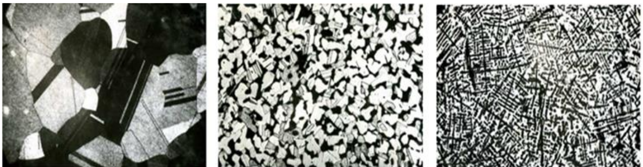
3.4 - rasm. Misning tarkibi va qotishmalari: a – bir fazali jez, b - ikki fazali jez, v – bronza.
