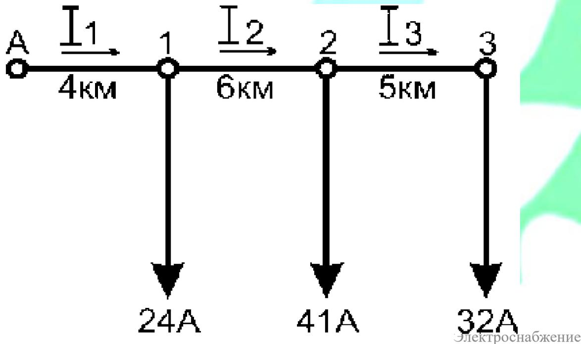
Рис.2. Схема распределения нагрузок потребителей.
