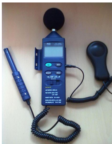
3 rasm. PCE EM-882 birlashtirilgan o'lchash vositasi.
