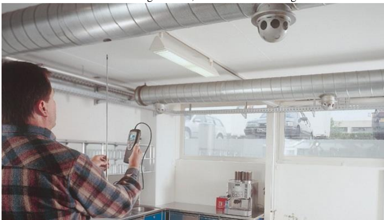
25 rasm. Mikroiklimni o'lchash
