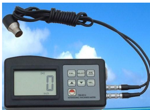
4 rasm. Ultratovush qalinligi o'lchagichi MT 8812.
