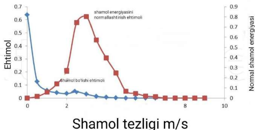
5-rasm. Shamol va shamol tezligining pastligi sinov maydonchasidan shamol energiyasining normallashtirilgan ehtimoli
