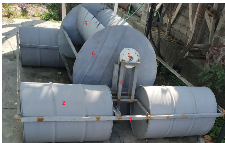
1-rasm. Mikro GES fizik tajriba qurilmasi. 1-kichik tezlikli generator, 2-ponton, 3-mikro GES ramasi, 4-generatorni ushlab turuvchi asos, 5-lopastlari, 6-ishchi g'ildirak lopastlarni ushlab turuvchi disklar.
