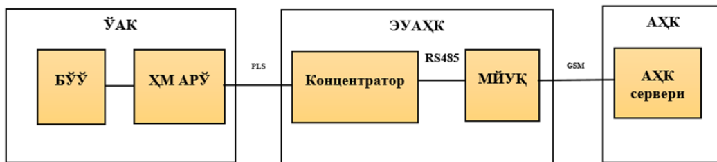
5-расм. Электр энергия тижорат ҳисобининг автоматлаштирилган ахборот-ўлчов тизими (ЭЭТҲААЎТ)нинг ўлчаш каналининг структуравий схемаси
